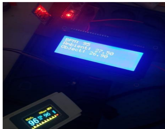
Ilustración 26 Comparativa de datos entre oxímetro de pulso y sistema del prototipo
