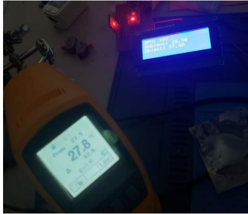
Ilustración 27 Comparativa datos de termómetro y datos del sistema del prototipo
