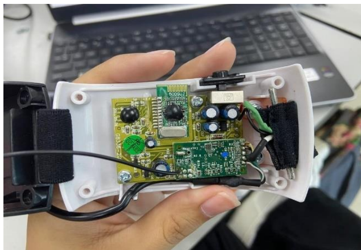
Ilustración 12. Placa de Mindflex
