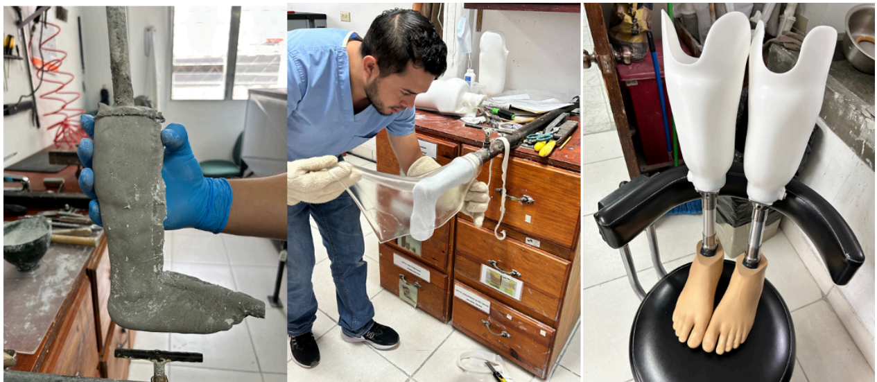
Ilustración 9. Proceso de fabricación de órtesis y prótesis.
