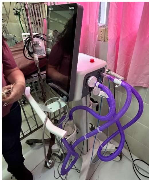
Ilustración 20. Ventilador mecánico Axcent Lyra x2.
