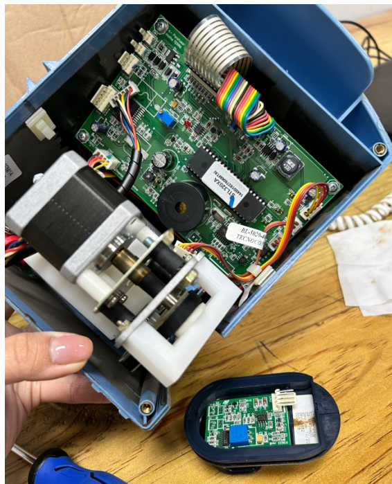
Ilustración 36. Interior de la bomba de infusión Samtronic ST 1000.
