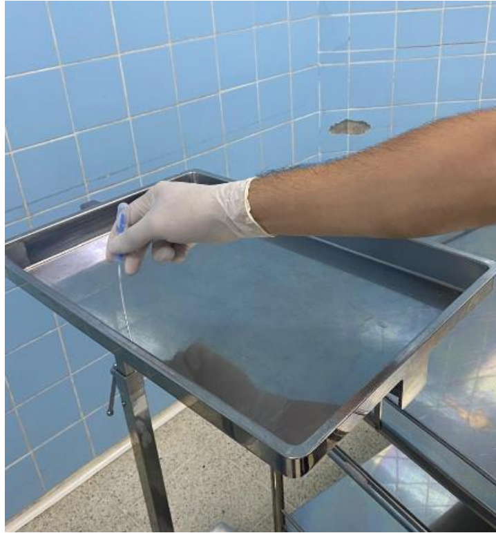
Anexo 8: Toma de muestra con prueba de proteínas residuales.
