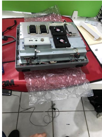
Ilustración 52. Mantenimiento correctivo en ultrasonido portátil.
