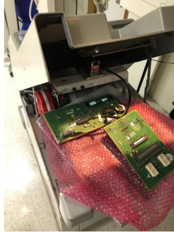
Ilustración 46. Diagnóstico de tarjeta de display.
