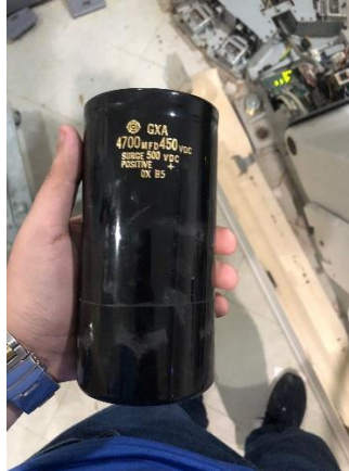
Anexo 1. Capacitador cambiado del PDU.
