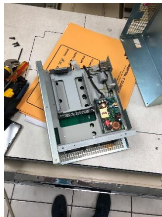
Anexo 2. Cambio de disco duro de la consola del brazo en C.
