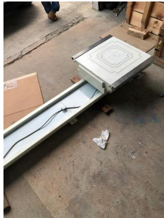
Ilustración 39. Bucky de pared siendo ensamblado.
