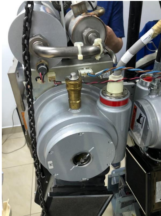
Ilustración 35. Tubo de Rx para prueba de tubo.
