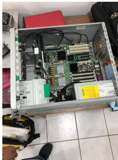
Ilustración 53. Mantenimiento correctivo en estación de trabajo.
