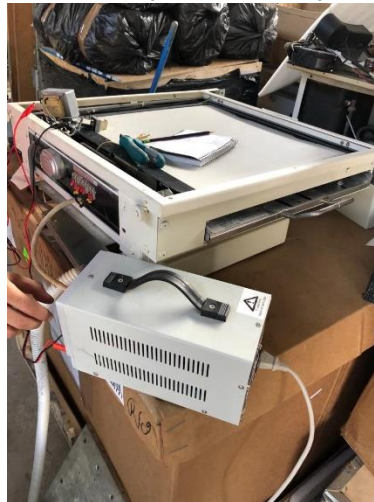
Ilustración 37. Prueba de Bucky de pared.
