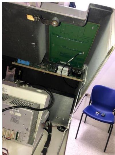
Ilustración 47. Cambio completado de tarjeta de display.
