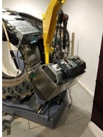
Ilustración 15. Cambio de Tanque de aceite de una TAC.
