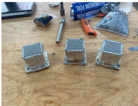
Ilustración 33 Moldes para cubos de mortero polimérico Brickaffix de 2x2x2 in
