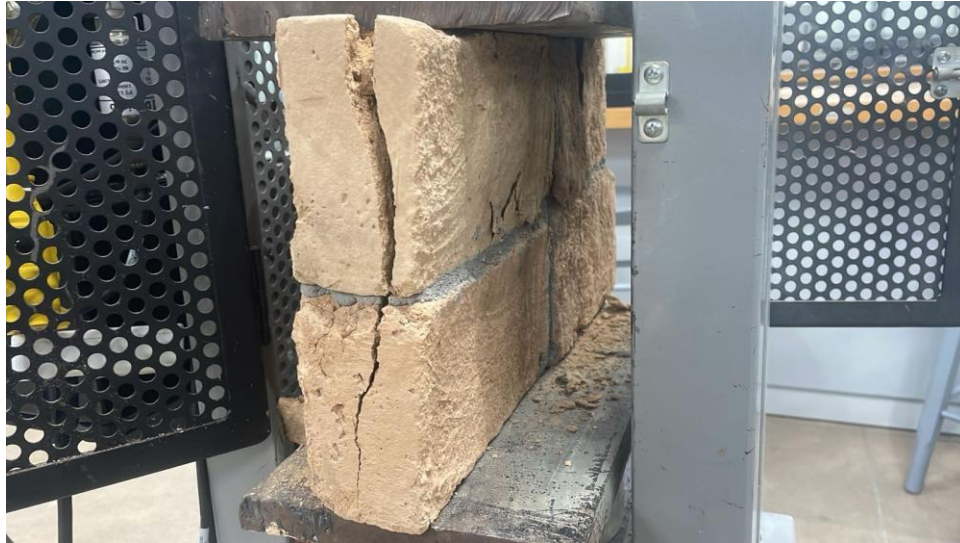
Ilustración 54 Ensayo de mampostería con mortero polimérico Brickaffix
