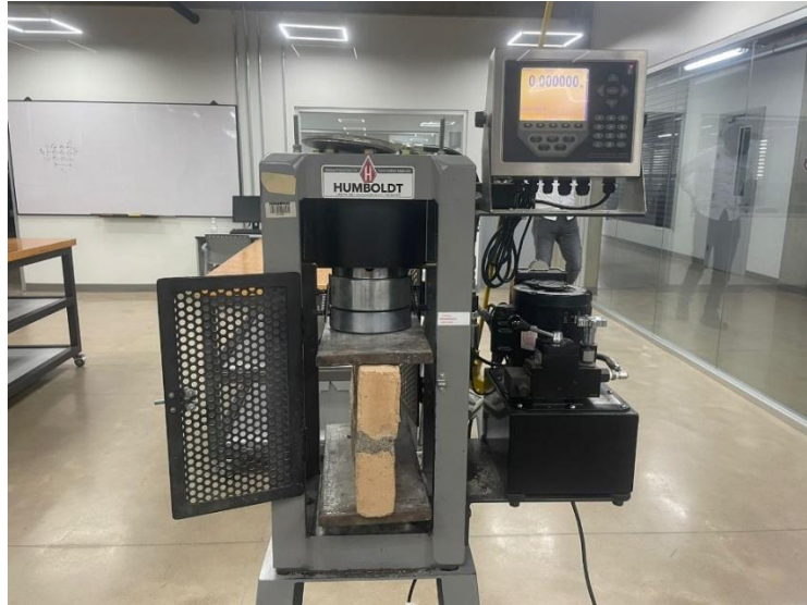
Ilustración 52 Ensayo de mampostería con dosificación 1:5
