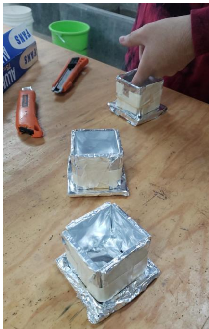
Ilustración 36 Moldes para mortero polimérico Brickaffix en el ensayo de compresión
