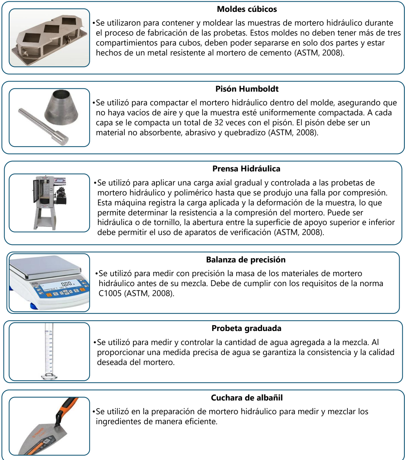
Gráfica 6 Herramientas y equipo utilizados en el ensayo de compresión
