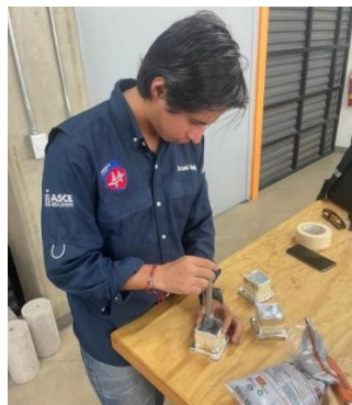
Ilustración 39 Elaboración de probetas de mortero polimérico Brickaffix para el ensayo de compresión
