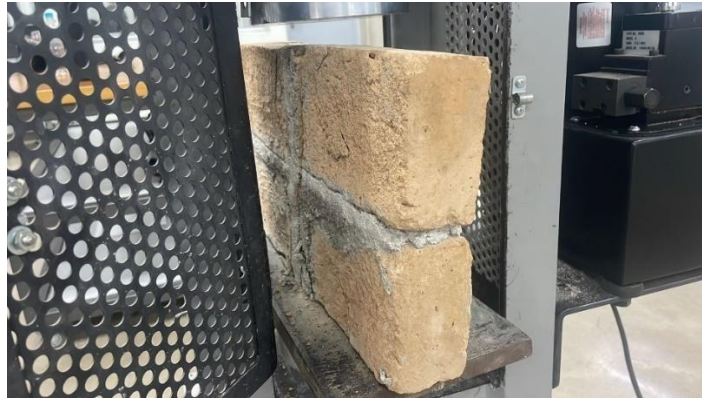
Ilustración 50 Ensayo de mampostería con dosificación 1:4
