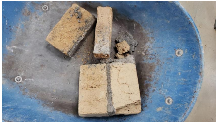
Ilustración 53 Resultado de ensayo de mampostería con dosificación 1:5
