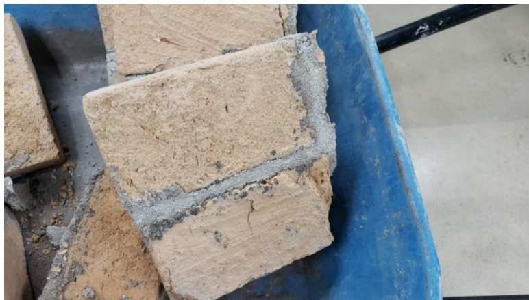
Ilustración 49 Resultado de ensayo de mampostería con dosificación 1:3
