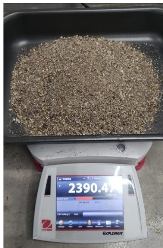
Ilustración 37 Peso de la arena para la dosificación 1:4
