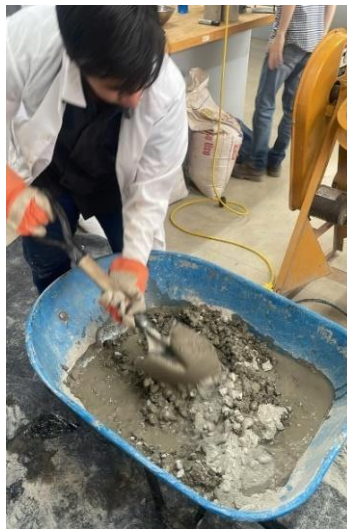
Ilustración 3 Preparación de mezcla de mortero hidráulico en el laboratorio de Ingeniería Civil de UNITEC
