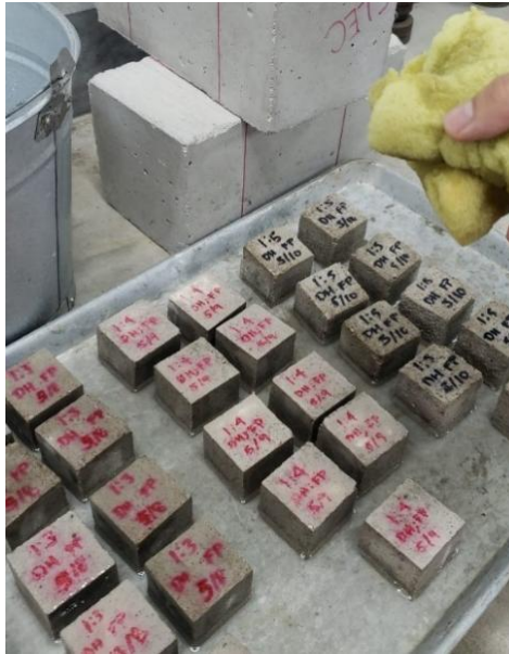
Ilustración 40 Curado de probetas de mortero hidráulico para el ensayo de compresión
