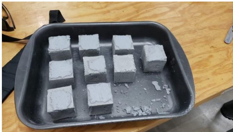
Ilustración 41 Enrasado de cubos de mortero polimérico Brickaffix
