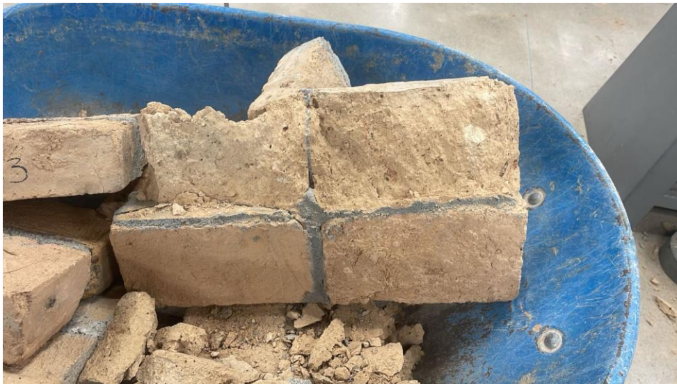
Ilustración 55 Resultado de ensayo de mampostería con mortero polimérico Brickaffix
