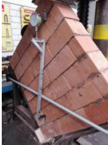
Ilustración 20 Ensayo de compresión diagonal en muretes
