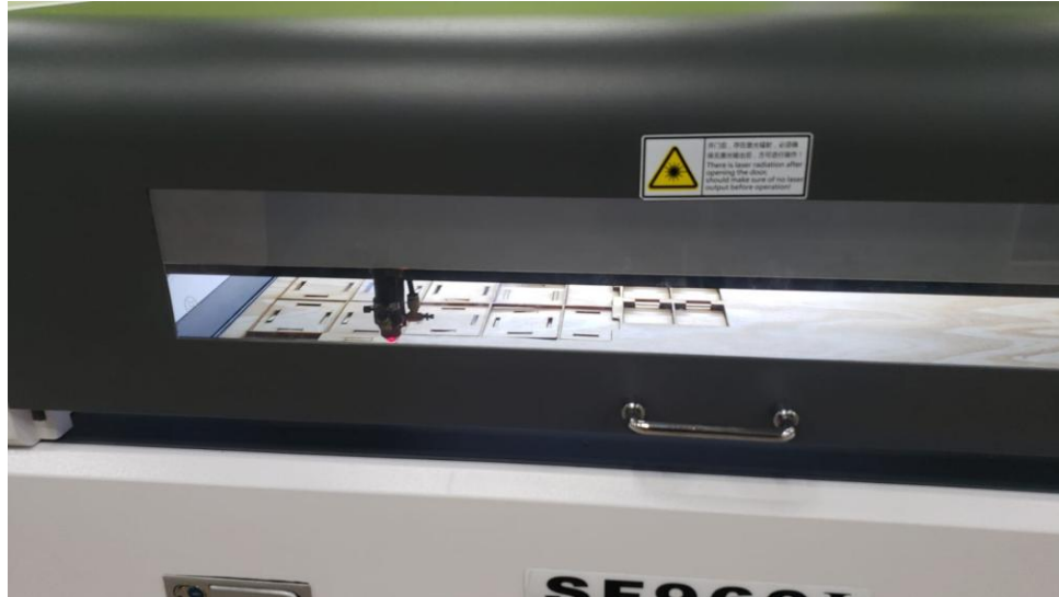
Ilustración 35 Fabricación de moldes para Brickaffix con cortadora láser en el FAB Lab
