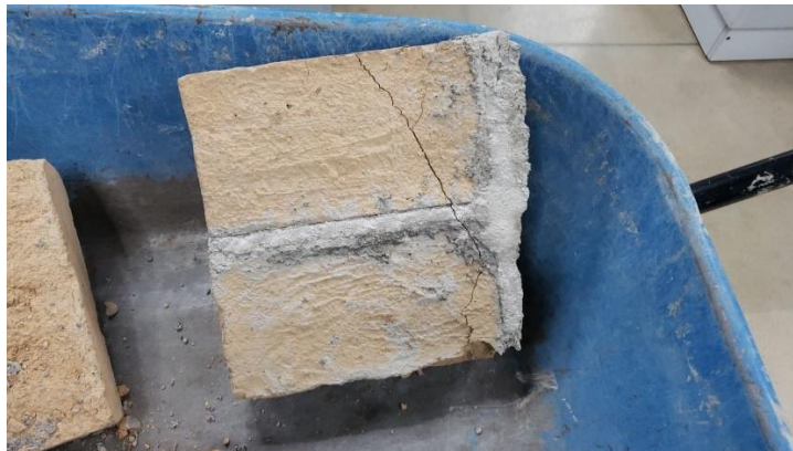
Ilustración 51 Resultado de ensayo de mampostería con dosificación 1:4
