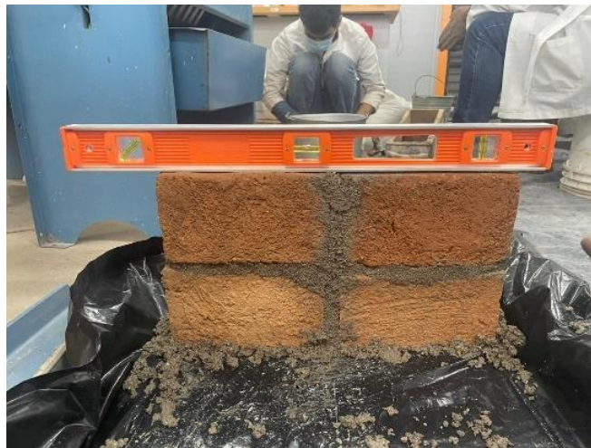
Ilustración 46 Verificación del nivel en probeta para ensayo de mampostería
