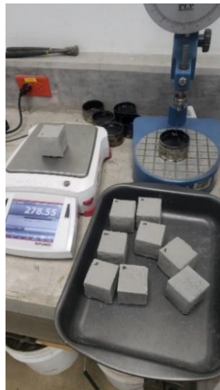
Ilustración 45 Medición del peso de probetas de mortero tras 24 Horas en el horno
