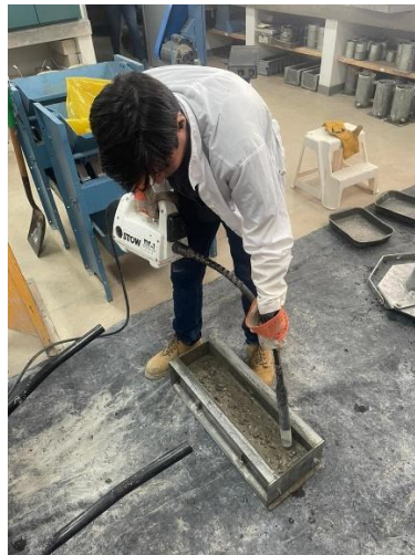
Ilustración 43 Vibrado del concreto para la elaboración de la viga
