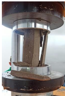
Ilustración 15 Ensayos de laboratorio para la validación de morteros poliméricos
