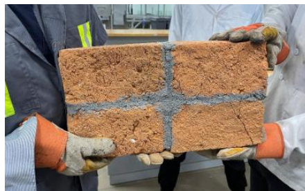
Ilustración 26 Ensayo de resistencia de mampostería liga de 1.5 cm
