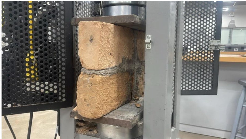
Ilustración 48 Ensayo de mampostería con dosificación 1:3
