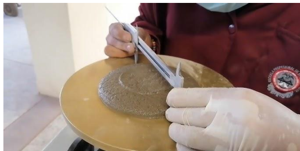
Ilustración 16 Ensayo de Flujo para Medir la Manejabilidad del Mortero Polimérico
