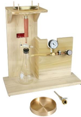
Ilustración 17 Instrumento utilizado en el ensayo de retención de agua para morteros
