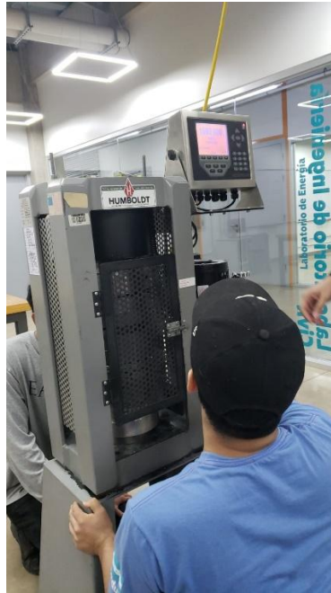
Ilustración 42 Ensayo de compresión con prensa hidráulica
