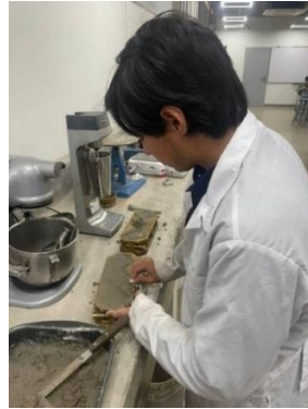
Ilustración 38 Elaboración de probetas de mortero hidráulico para el ensayo de compresión
