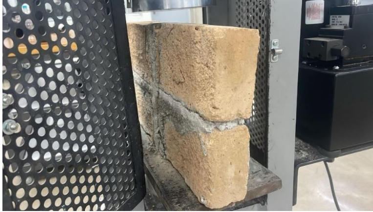
Ilustración 47 Probeta de ensayo junta en mampostería previo al ensayo de mampostería
