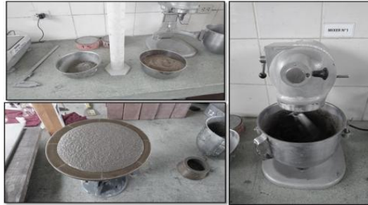
Ilustración 25 Procedimiento de ensayo de fluidez
