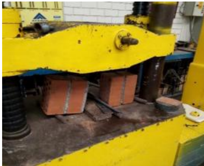
Ilustración 22 Ensayo de tracción por flexión en pilas con mortero hidráulico
