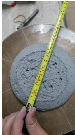
Ilustración 44 Medición del diámetro de flujo del mortero polimérico Brickaffix
