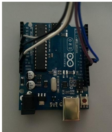
Ilustración 11. Conexión de cableado eléctrico del Arduino
