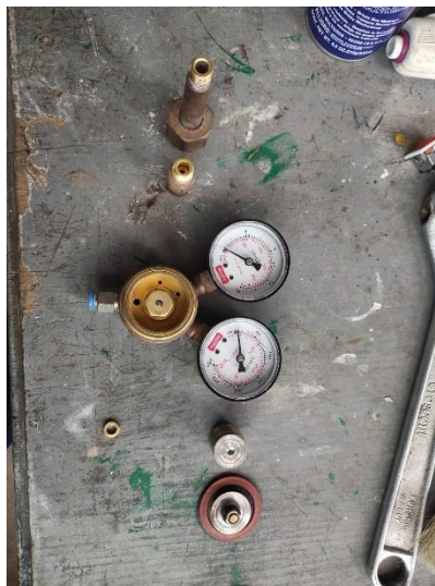
Ilustración 35 – Limpieza de manómetro
