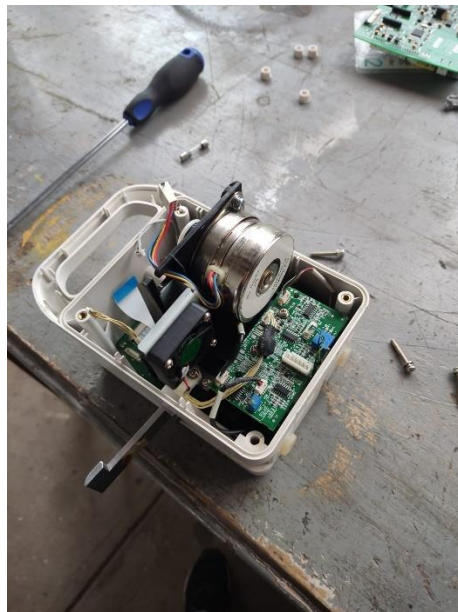
Ilustración 62 – Motor en mal estado
