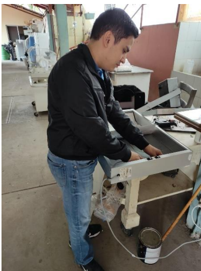
Ilustración 30 – Adaptando luces led al negatoscopio
