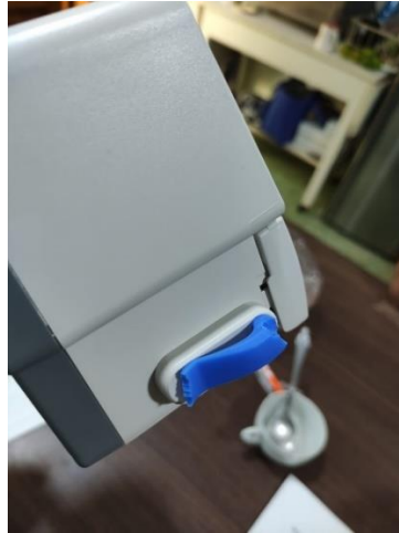
Ilustración 42 – Bomba nueva con defecto
