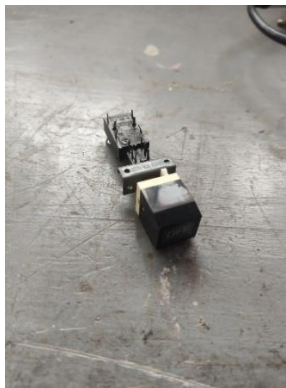
Ilustración 13 – Switch en mal estado
