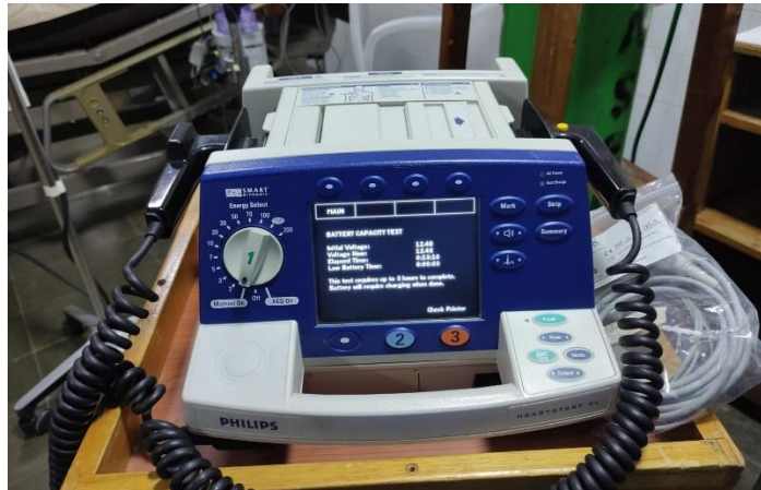
Ilustración 60 – Prueba de capacidad de batería
