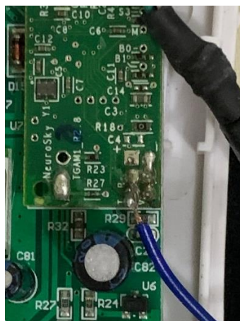
Ilustración 13. Terminal T (chip Neurosky).
