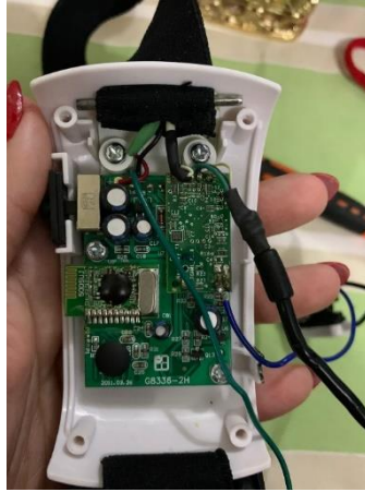
Ilustración 12. Circuito interno del Mindflex.
