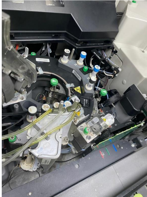
Ilustración 67: Válvulas y estación de lavado Architect i1000SR
