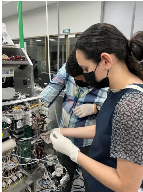
Ilustración 68: Cambio de válvula check del sistema neumático del Alinity Hq
