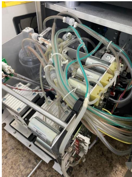
Ilustración 42: Sistema neumático interno del Ruby
