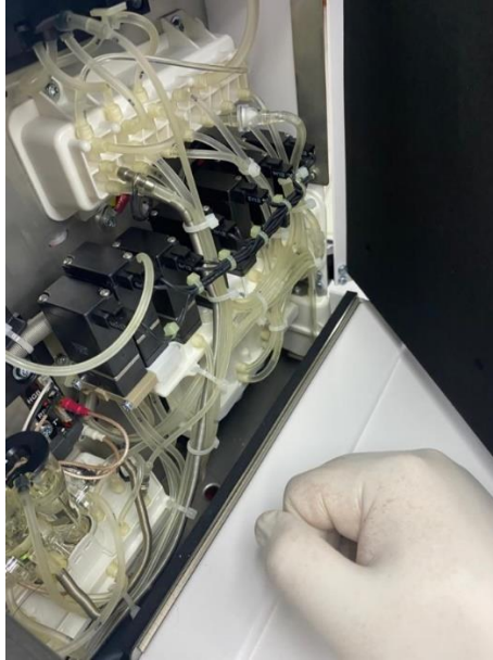
Ilustración 34: Manifold de válvulas del Emerald 22AL
