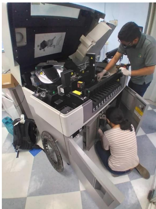
Ilustración 69: Realización de mantenimiento preventivo del i1000SR
