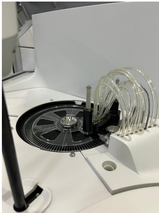
Ilustración 61: Estación de lavado del BA200
