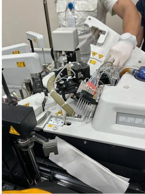
Ilustración 56: Estación de procesamiento del analizador Architect c4000
