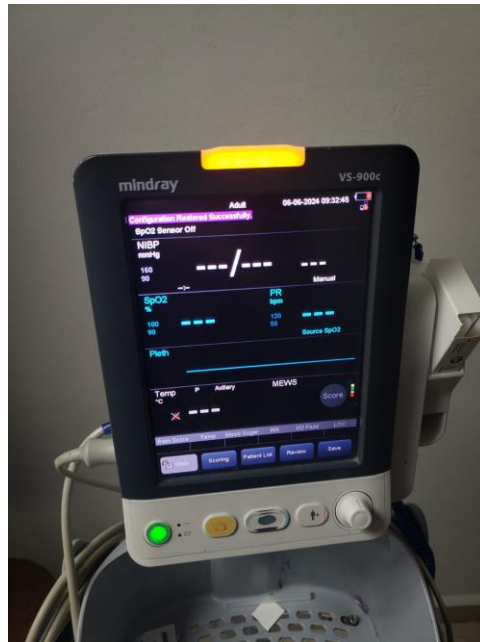
Anexo 24. Reemplazo de sensor de oximetría de monitor de signos vitales
