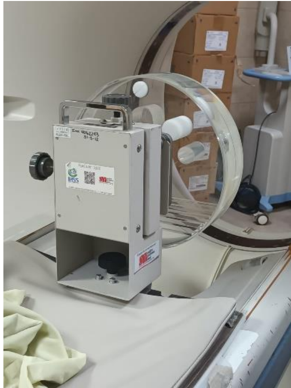
Ilustración 8. Calibración de tomógrafo mediante fantoma. Fuente: Propia (2022)
