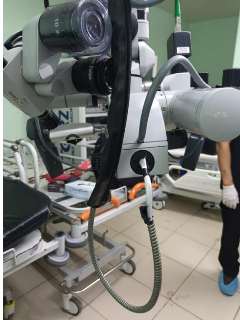
Ilustración 6. Cambio de fibra óptica de microscopio quirúrgico. Fuente: Propia (2022)
