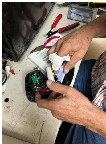
Ilustración 93 - Mantenimiento correctivo de batería de trepano
