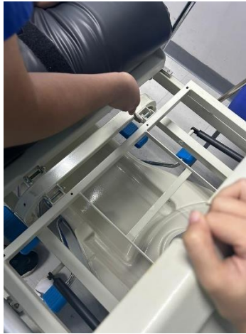
Ilustración 101 - Mantenimiento correctivo de camas hospitalaria
