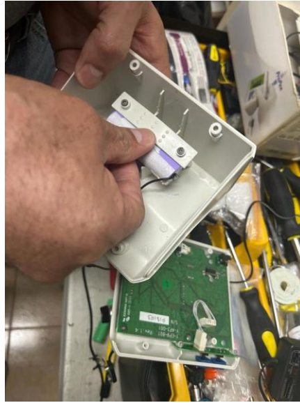
Ilustración 91 - Mantenimiento correctivo de localizador de ápices
