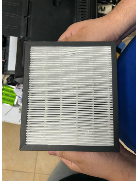
Ilustración 92 - Mantenimiento correctivo de filtros de calentador
