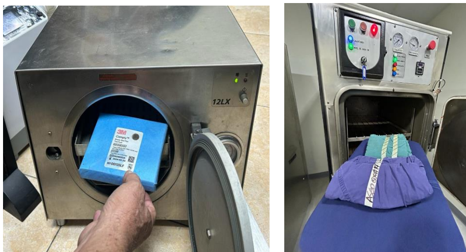
Ilustración 94 - Prueba de función de autoclaves
