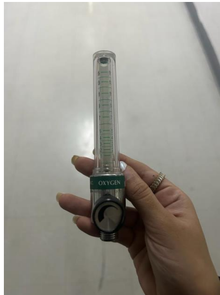
Ilustración 79 - Mantenimiento correctivo flujómetro
