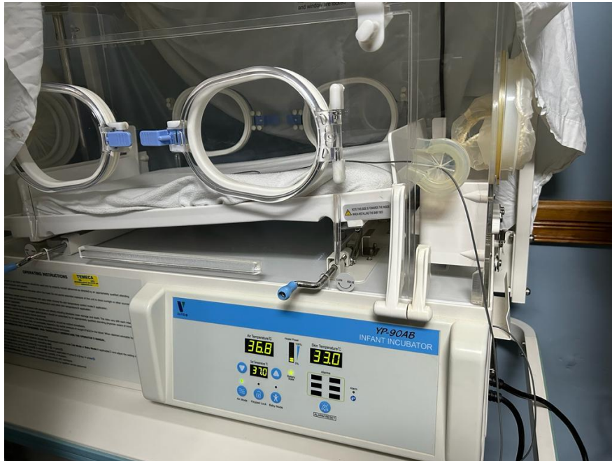
Ilustración 83 - Prueba de función de incubadora de transporte
