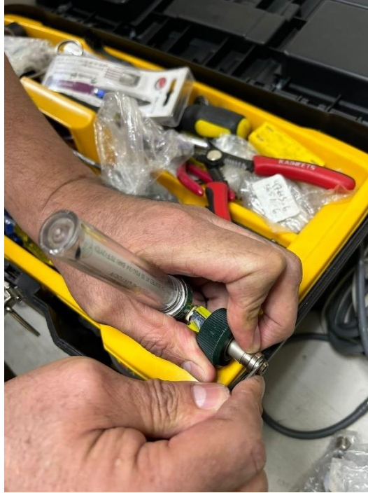
Ilustración 69 - Arreglo de flujómetro
