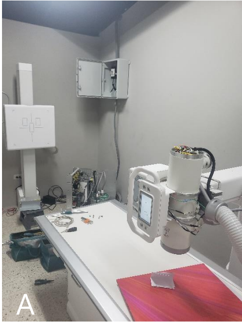
Ilustración 23. (A) Conexiones del tubo y generador (B) Alineación con bucky de pared
