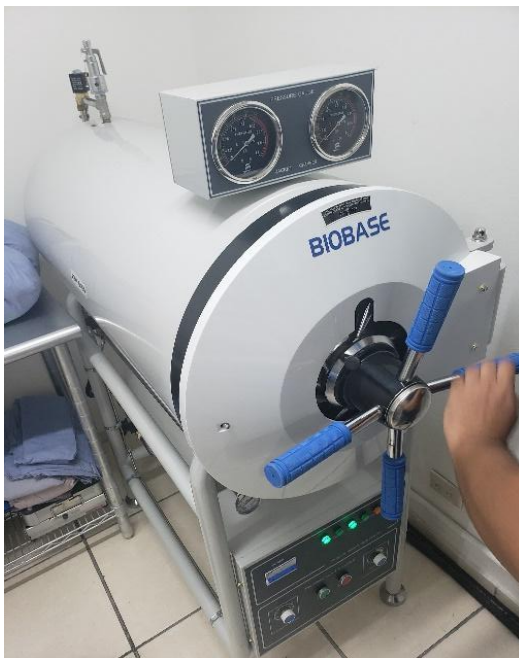
Ilustración 17. Evacuación de autoclave obstruido
