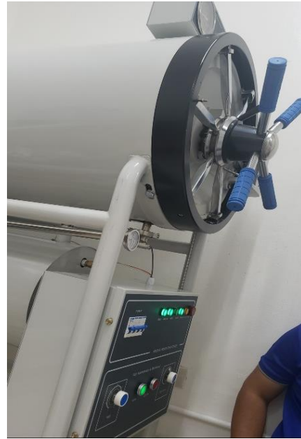
Ilustración 25. Verificando que no exista fugas en autoclave de vapor
