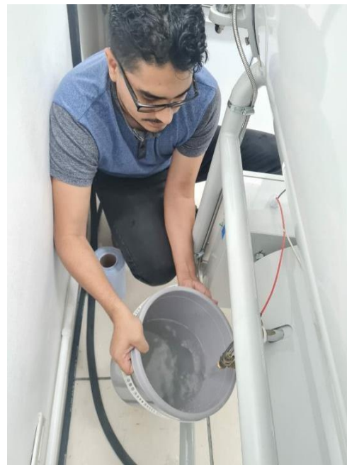
Ilustración 17. Evacuación de autoclave obstruido
