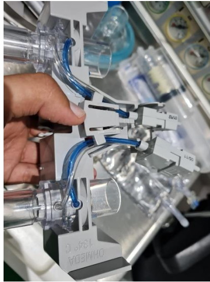
Ilustración 48. Cambio de sensores de flujo
