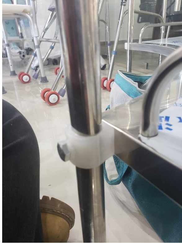
Ilustración 51. Reemplazo de soportes en mesa medialuna
