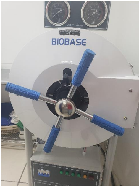
Ilustración 25. Verificando que no exista fugas en autoclave de vapor
