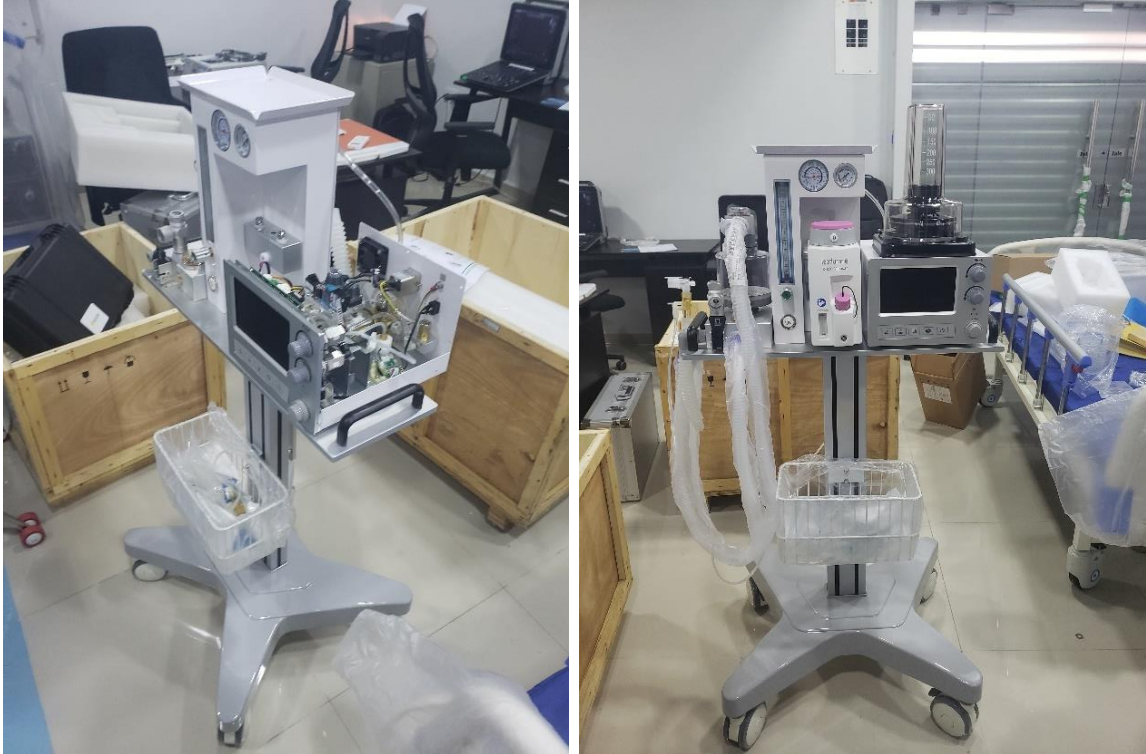
Ilustración 33. Ensamblaje de máquina de anestesia para veterinaria
