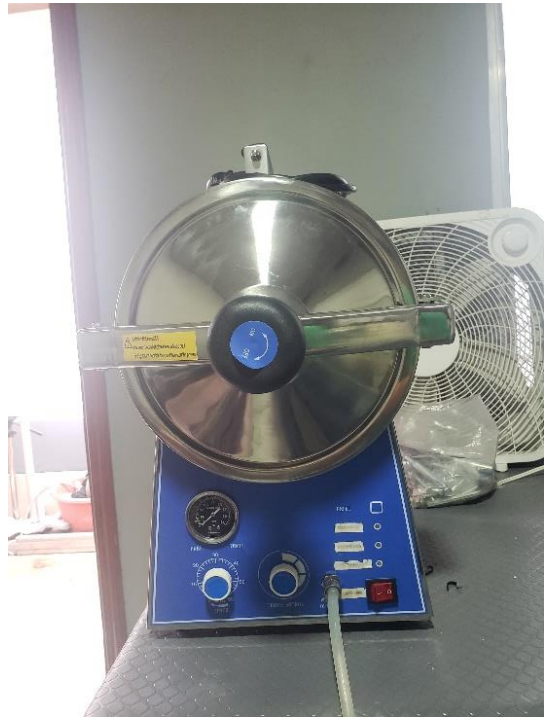
Ilustración 27. Autoclave de mesa que se le cambio el interruptor
