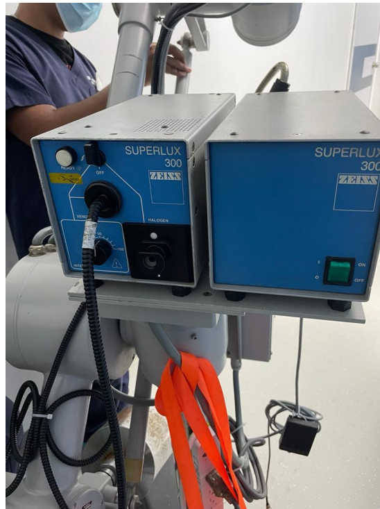
Ilustración 88 – Instalación de fuente de luz en microscopio quirúrgico
