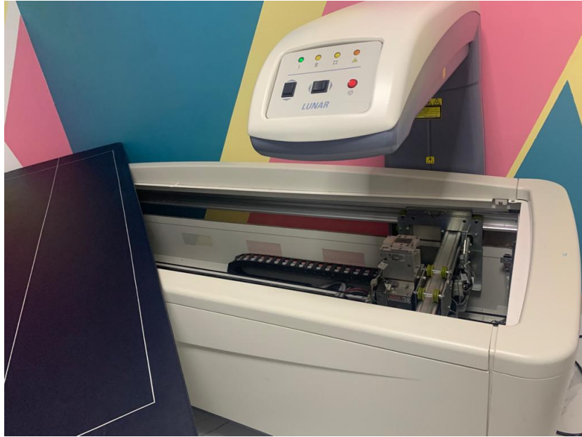
Ilustración 84 – Desmontaje de densitómetro
