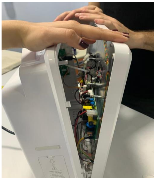
Ilustración 82 – Desmontaje de MSV
