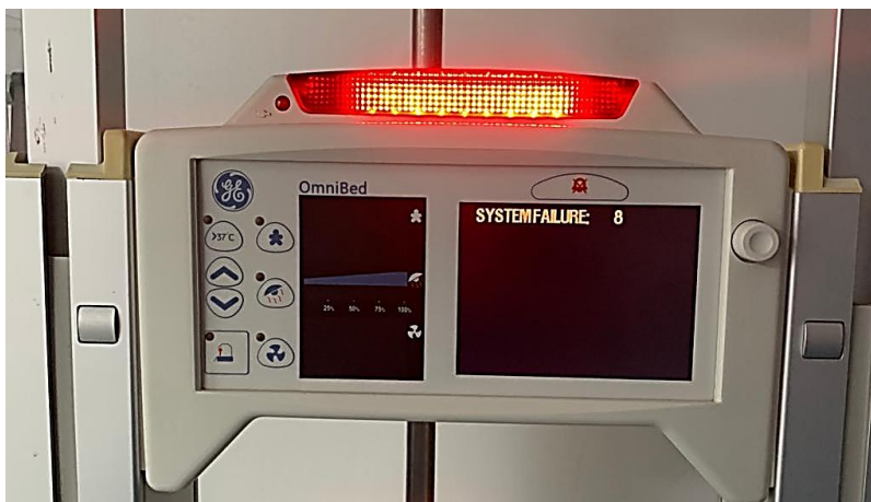
Ilustración 26 – Error 8 en incubadora Datex Ohmeda
