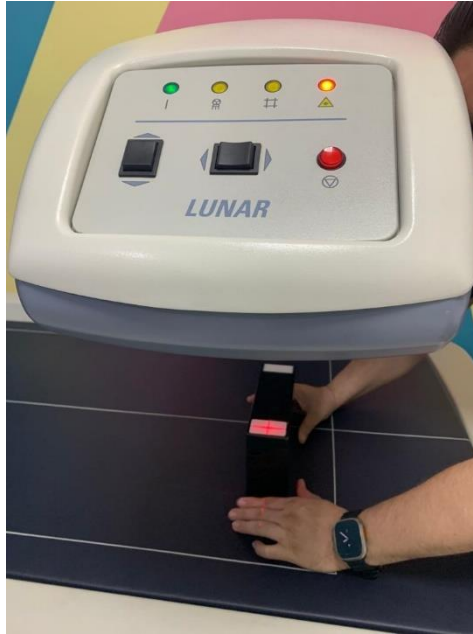
Ilustración 50 – Comprobación de movimientos mecánicos del densitómetro
