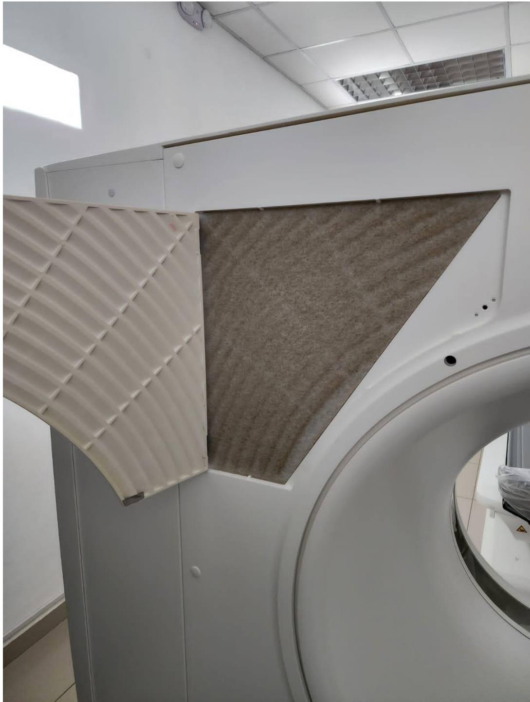
Ilustración 12- Chequeo del primer filtro de aire del Tomógrafo SOMATOM go Fuente: Autoría Propia.
