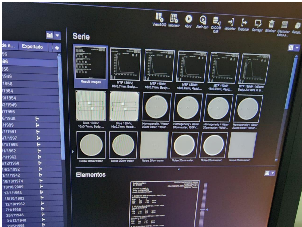
Ilustración 19- Comprobación Homogeneidad, ruido y cortes del phantom del Tomógrafo.
