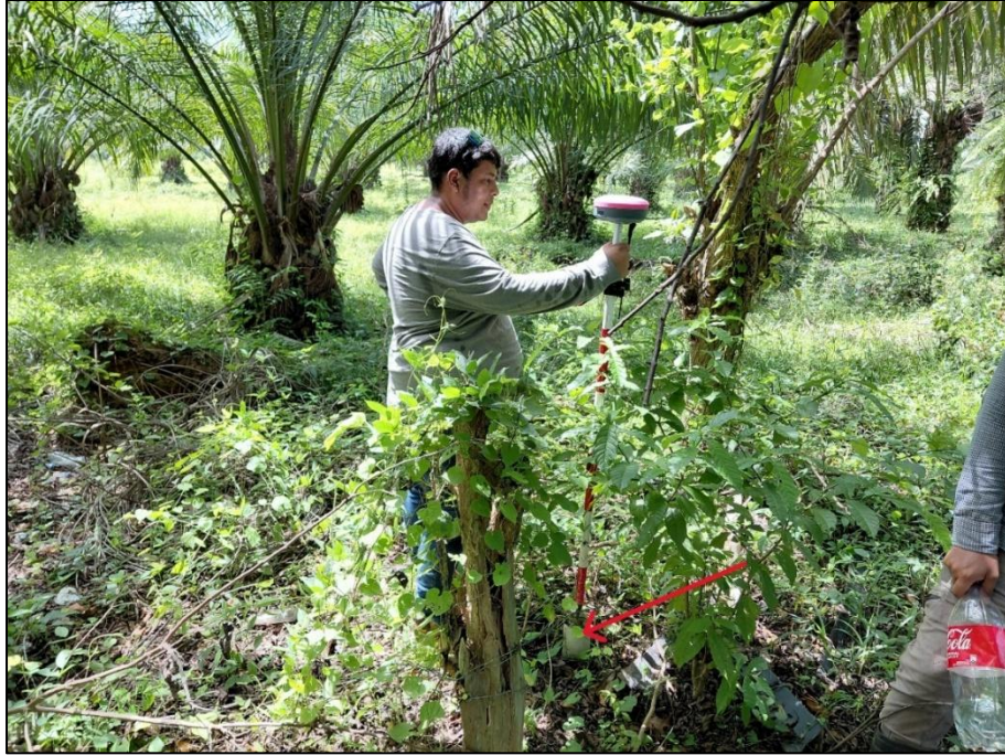
Figura 78. Ubicación de mingos de concreto para delimitación de terreno. Fuente: (Elaboración propia, 2025).
