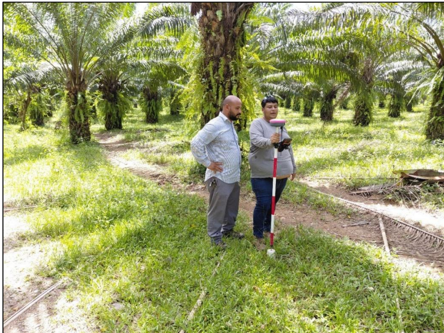
Figura 79. Levantamiento topográfico con equipo de cinemática en tiempo real (RTK). Fuente: (Elaboración propia, 2025).
