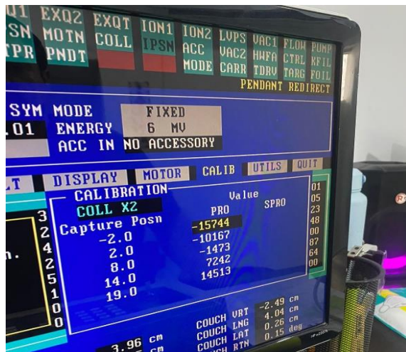
Anexo 39. Resultados antes de la prueba de calidad del colimador X2 del acelerador lineal.
