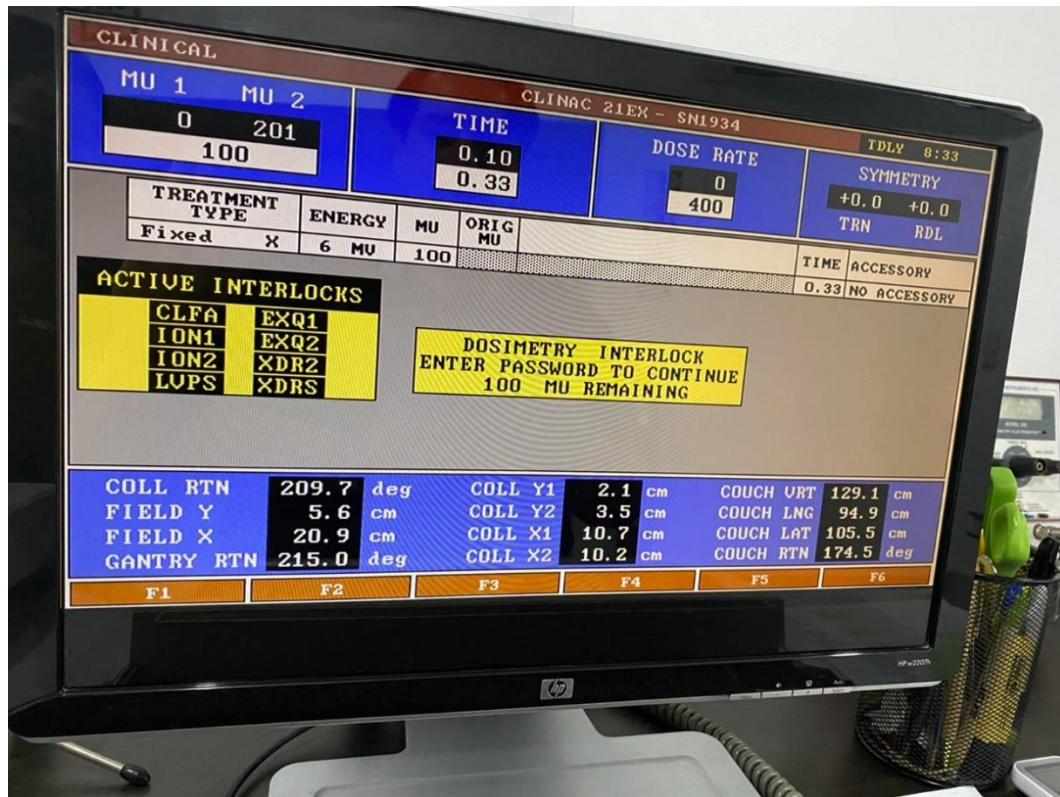
Anexo 62. Error mostrado en computadora del acelerador lineal (Active Interlocks).
