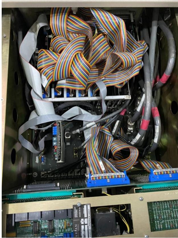
Anexo 60. Cambio de tarjeta en acelerador lineal.
