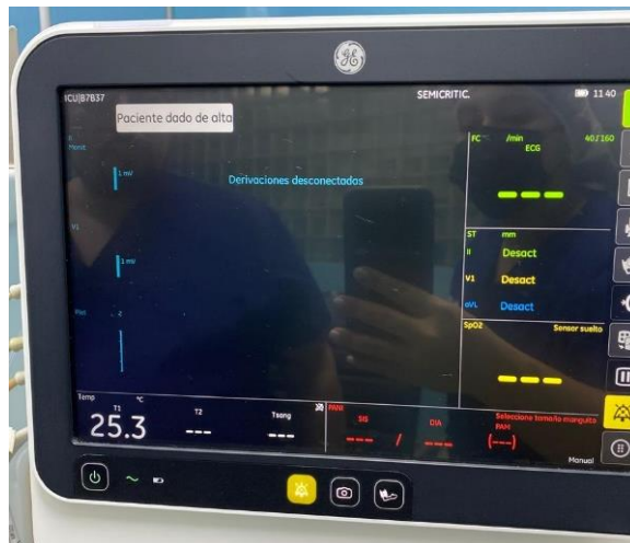
Anexo 10. Falta de demostración de señales en monitor de signo vitales.
