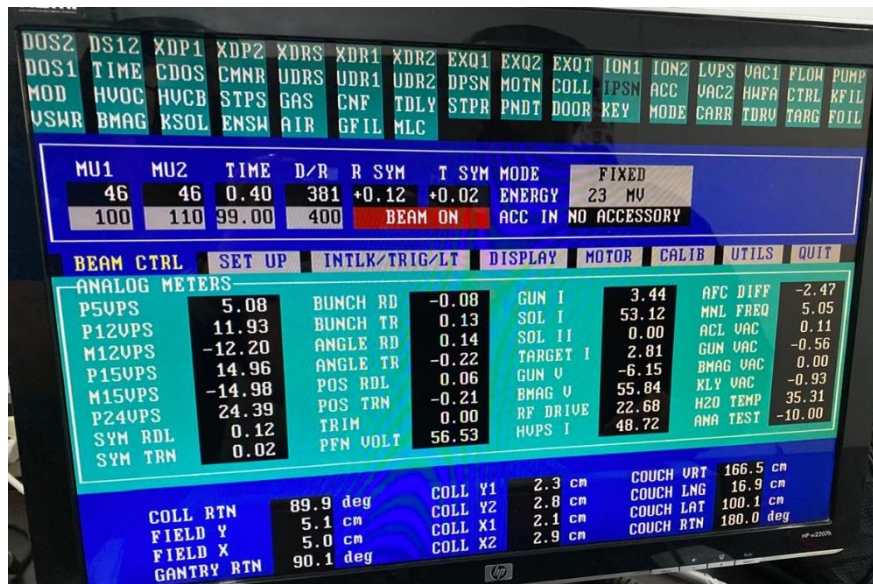
Anexo 14. Ajustes corregidos del acelerador lineal listo para usar.
