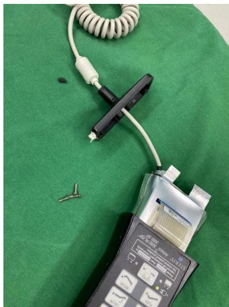
Anexo 15. Reparación de control de cama quirúrgica de sala de operaciones.
