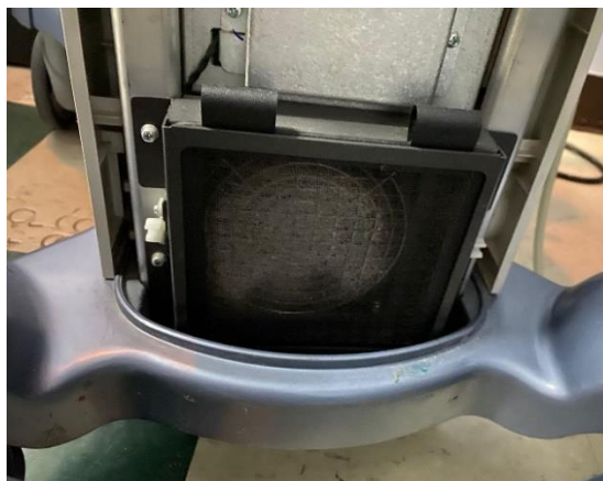
Anexo 16. Filtro causante de falla de apagado repentino en ultrasonido.
