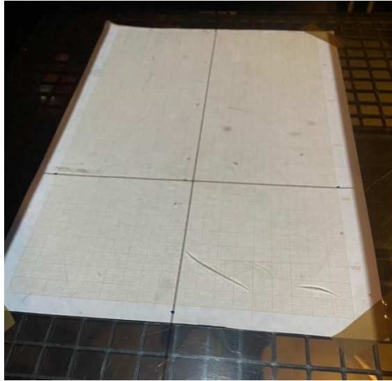
Anexo 38. Prueba de calidad con papel milimetrado en el acelerador lineal.
