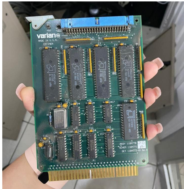
Anexo 61. Tarjeta cambiada en acelerador lineal.
