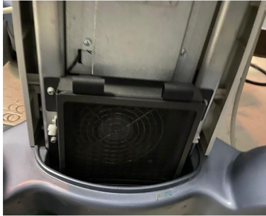
Anexo 17. Limpieza de filtros por problema presentado en ultrasonido.
