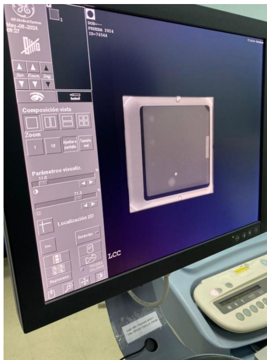
Anexo 23. Prueba con phantom en mamógrafo digital.
