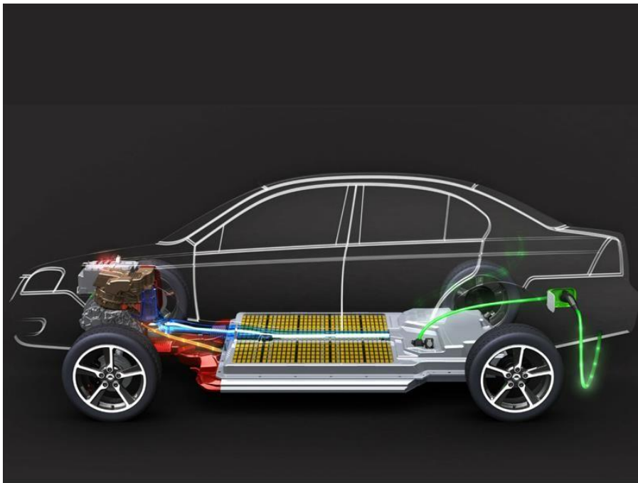
Figura 4.7: baterías de litio en un carro eléctrico
