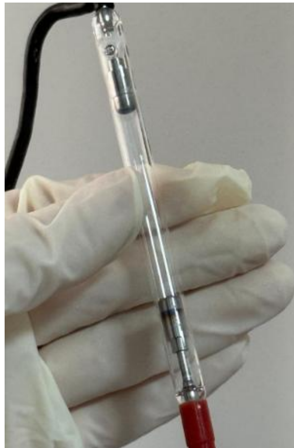
Ilustración 98 Lámpara dañada del aplicador de Exilite
