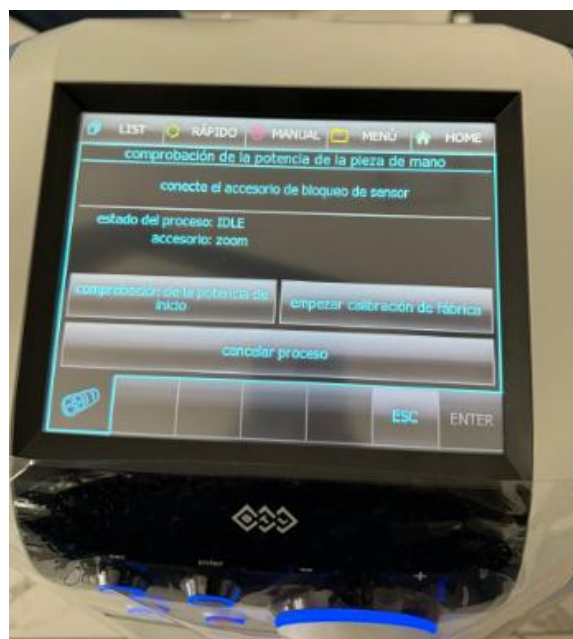
Ilustración 112 Comprobación de la potencia de la pieza de mano de HIL
