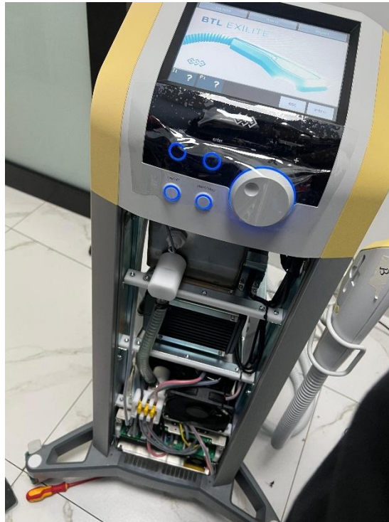
Ilustración 22 Pruebas de funcionamiento del EXILITE con visibilidad en el interior para comprobar el voltaje
