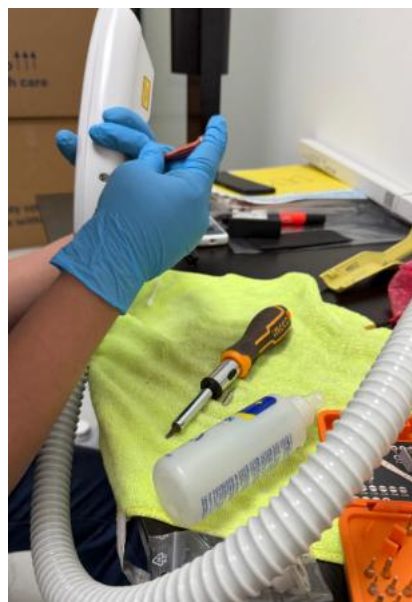
Ilustración 161 Cambio de lampara de aplicador de Exilite
