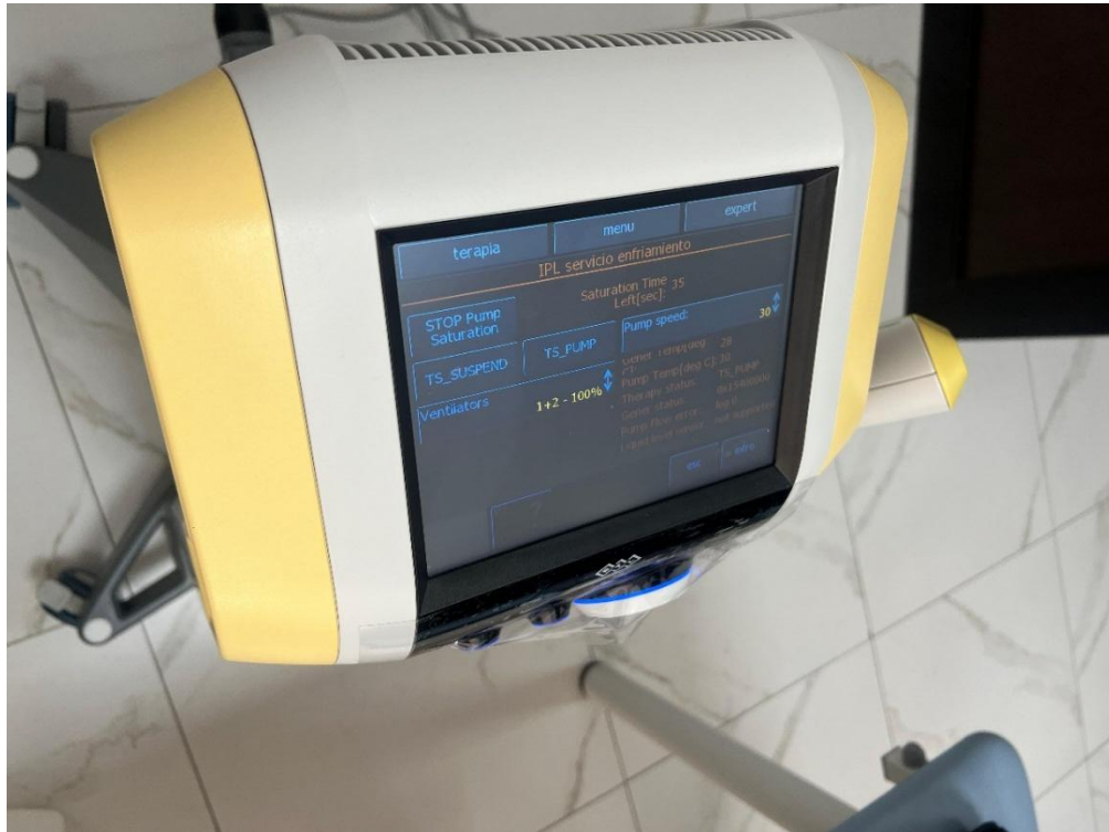
Ilustración 12 Bombeo en el perfil de servicio técnico del EXILITE previo a las pruebas de funcionamiento como usuario
