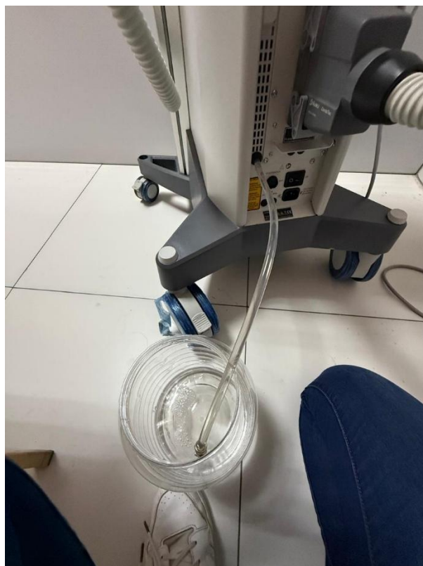
Ilustración 115 Cambio de agua destilada a exilite
