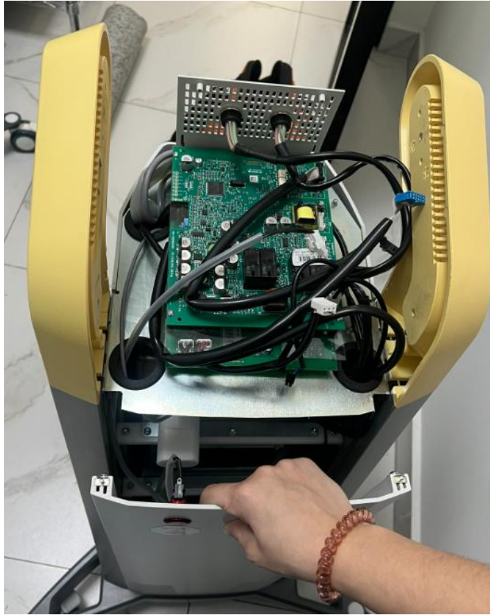
Ilustración 45 Parte Interna de EXILITE
