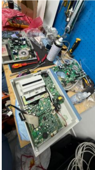
Ilustración 209 Mantenimiento Correctivo ECG
