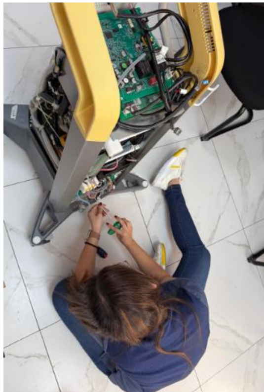
Ilustración 170 Cambio de fuente a Exilite
