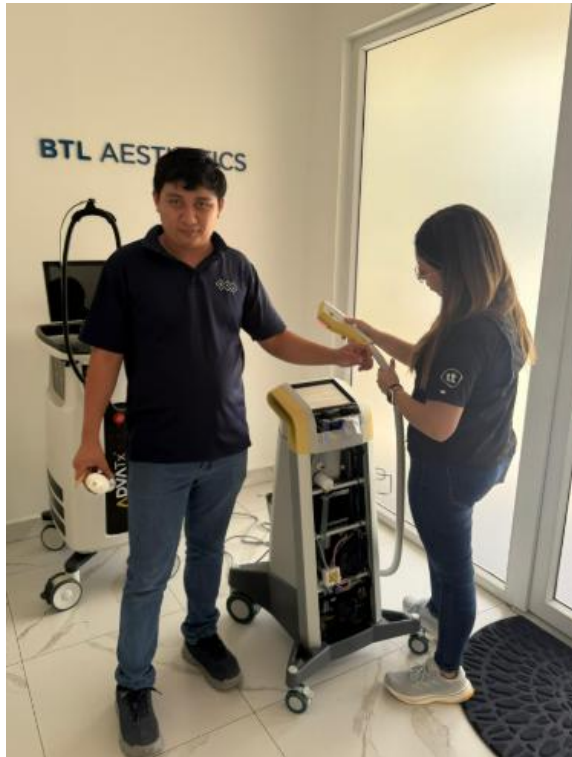
Ilustración 16 Prueba de funcionamiento del EXILITE en modo usuario
