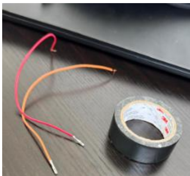
Ilustración 116 Adaptación de jumpers para encajarlo en conector de celda de oxígeno.
