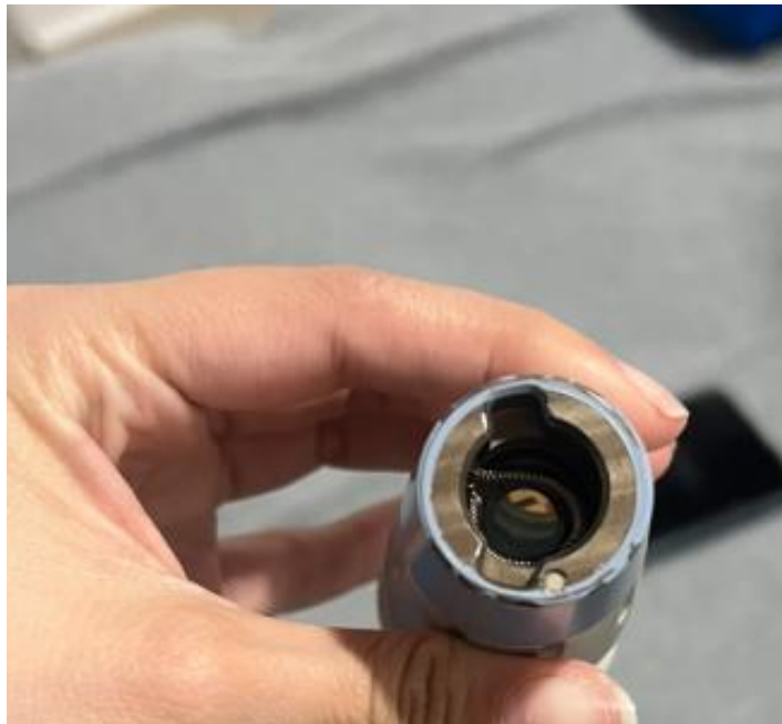
Ilustración 50 Aplicador del HIL dañado debido a golpe
