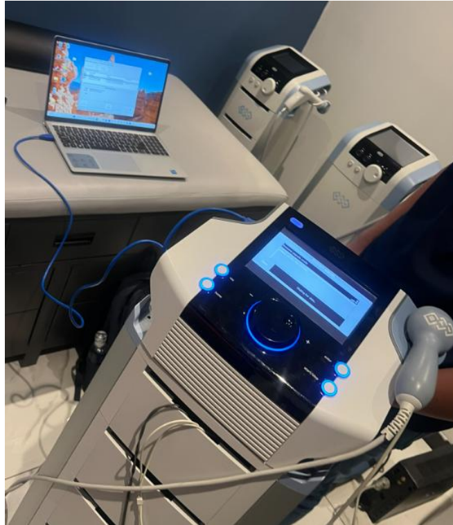
Ilustración 27 Actualización de software de BTL 5000 (Ultrasonido & electroterapia)
