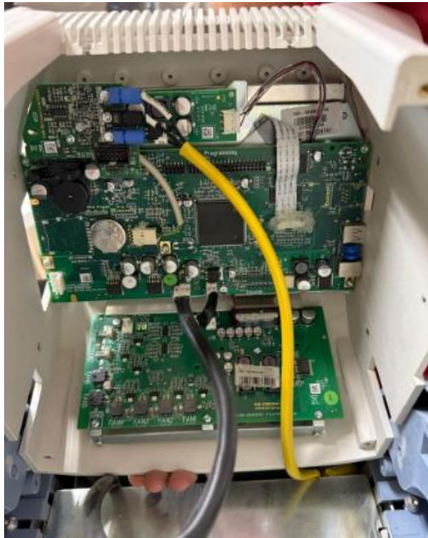
Ilustración 133 Cambio de la master del SIS
