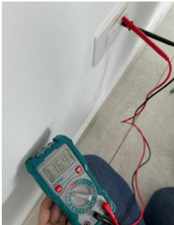
Ilustración 80 Medición de Voltaje en Tomas
