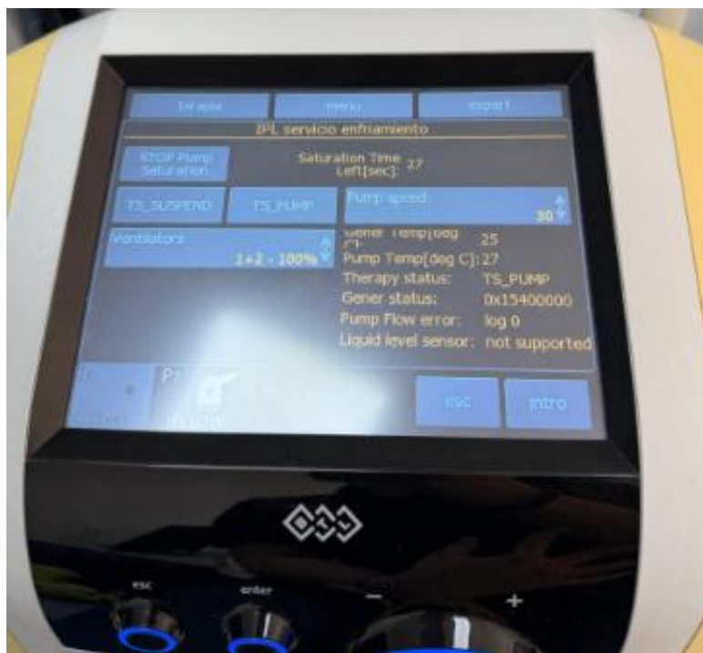
Ilustración 104 Bombeo para el servicio de enfriamiento de IPL
