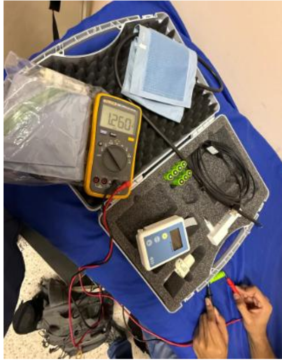
Ilustración 127 Inspección del estado de las baterías del MAPA
