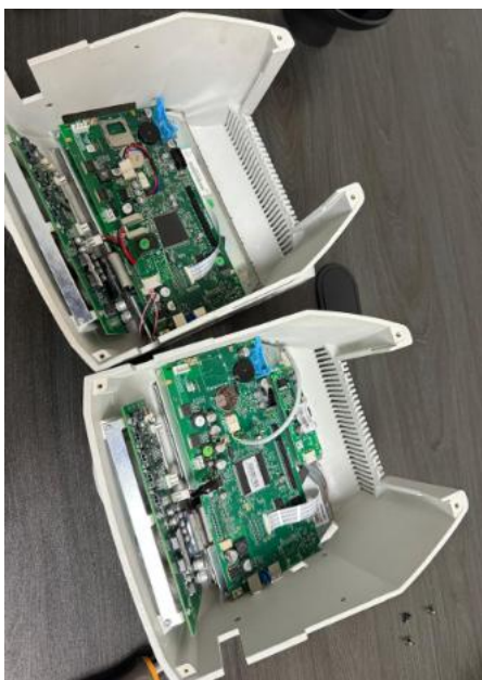
Ilustración 163 Inspección interna de Exilite
