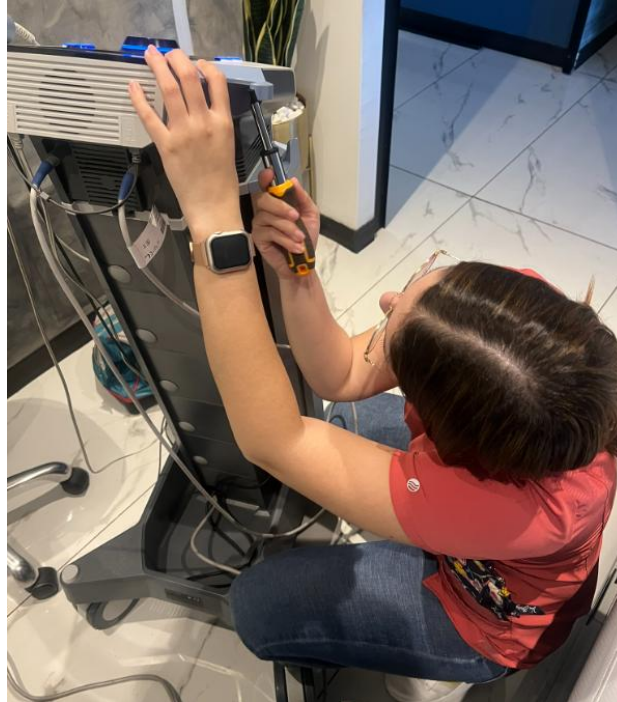
Ilustración 25 Removiendo carcasa para conectar cable USB a computadora
