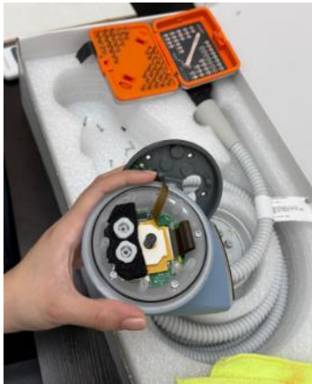
Ilustración 102 Comprobación del arreglo del botón de forma interna del aplicador
