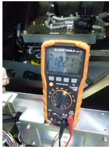
Ilustración 33. Ajuste de voltaje en puerto de la fuente de TC
