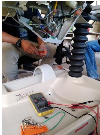
Ilustración 26. Cableado interno camilla Stryker 1030
