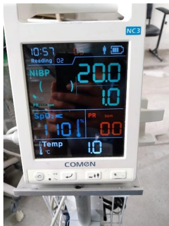
Ilustración 70. Configuración de la interfaz de servicio del MSV Comen NC3
