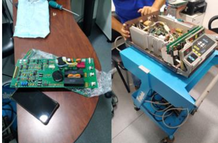
Ilustración 79. Supervisión del cambio de la tarjeta de la fuente del electrocauterio Valleylab Force 2
