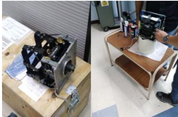
Ilustración 40. Limpieza del colimador del Rx estacionario
