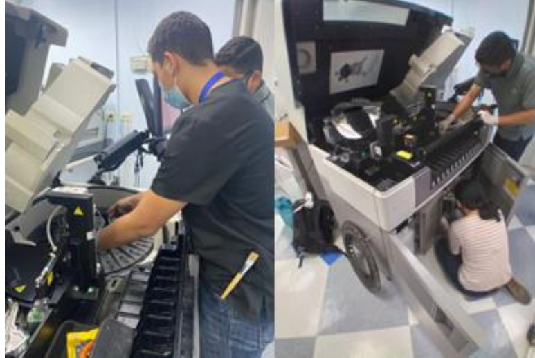
Ilustración 55. MP a equipo Architect Plus i1000SR
