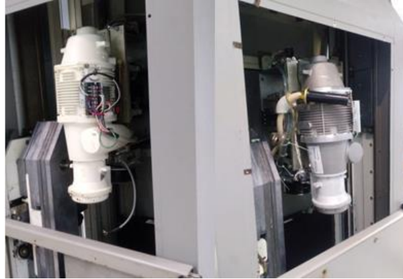
Ilustración 39. Cambio del tubo de Rx estacionario
