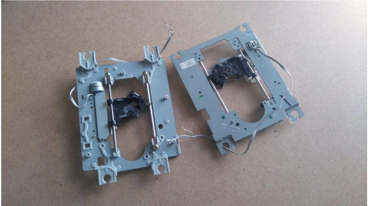
Figura 4. 25 Dvd's desmontados para motores paso a paso.
