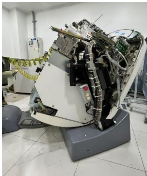
Anexo 7: Inyección de Aceite Dieléctrico a Tomógrafo
