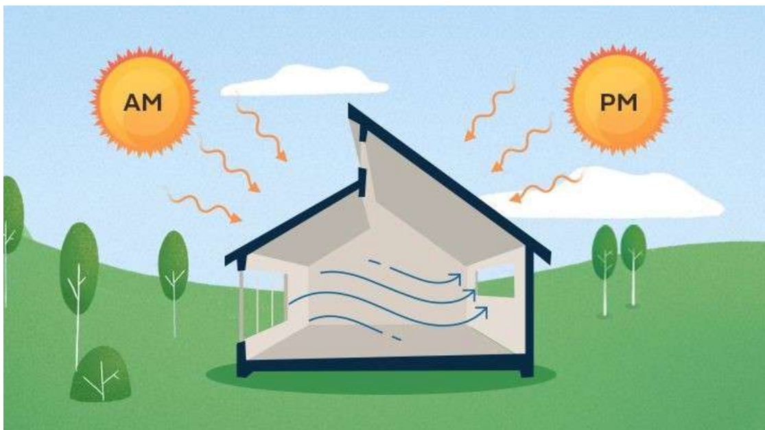
Figura 6. Interacción entre el Asoleamiento y la Ventilación Natural en el Diseño Bioclimático
