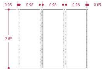
DETALLE EN PLANTA DE CIELO FALSO ESCALA 1:20
