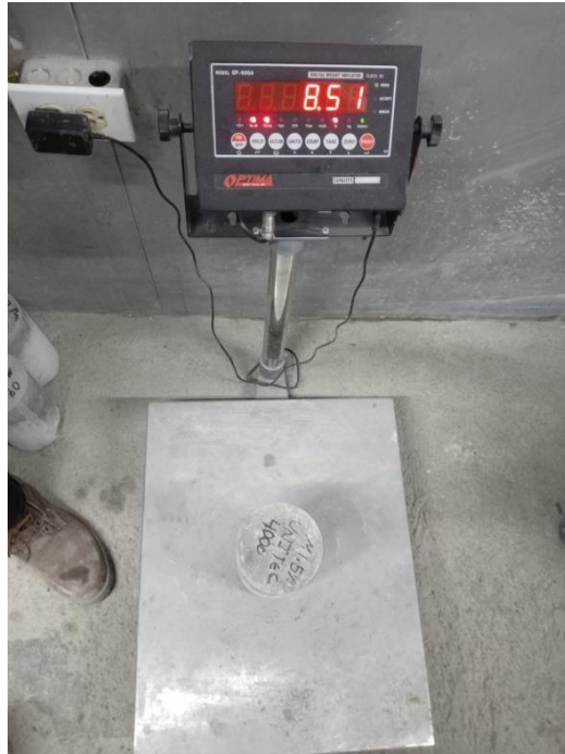
Ilustración 73. Peso de cilindro de concreto.
