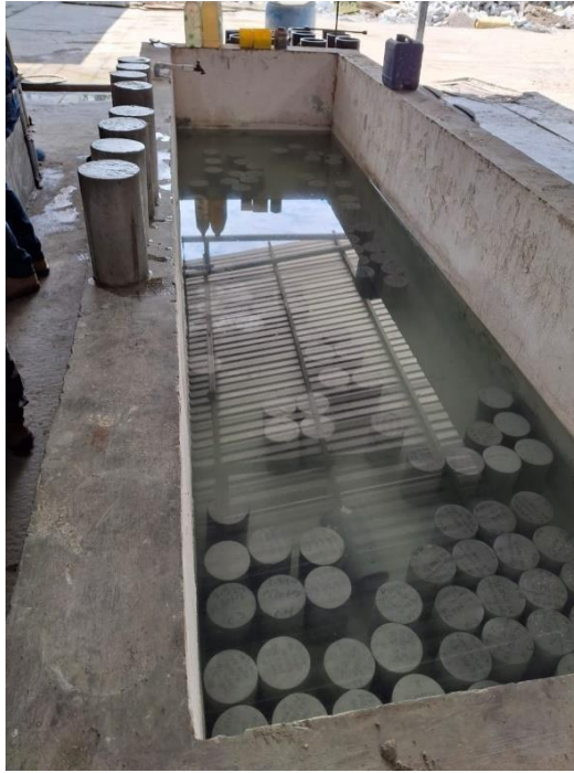
Ilustración 71. Proceso de curado de las muestras de concreto.
