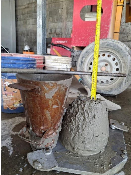
Ilustración 65. Revenimiento de la mezcla de concreto con fibra de banano.
