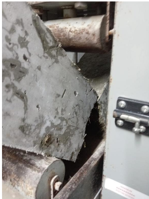
Ilustración 76. Ruptura de viga de concreto con fibra de banano.
