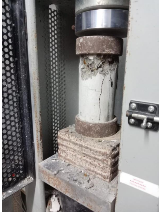
Ilustración 75. Ruptura de cilindro de concreto con fibra de banano
