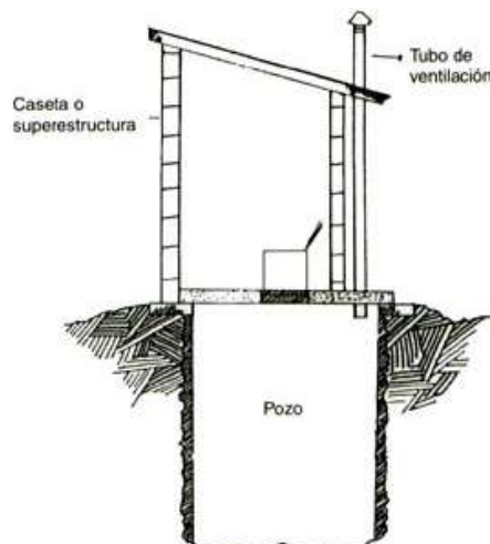
Ilustración 55. Corte transversal sistema de letrina
