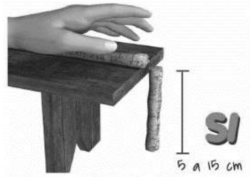
Ilustración 87. Adecuada proporción de barro y arena
