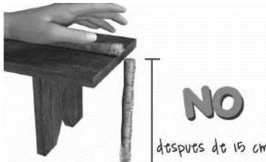
Ilustración 89. Exceso de barro en la prueba
