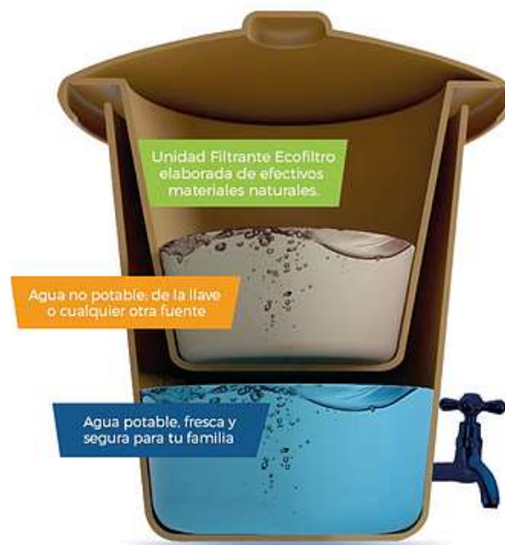
Ilustración 61. Sistema de filtración ecofiltro
