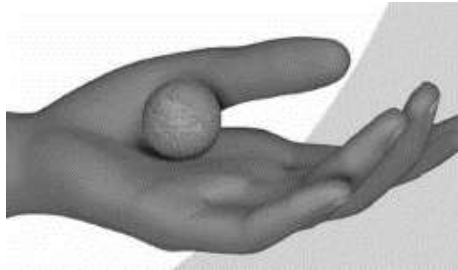
Ilustración 85. Prueba para conocer si la tierra encontrada tiene barro
