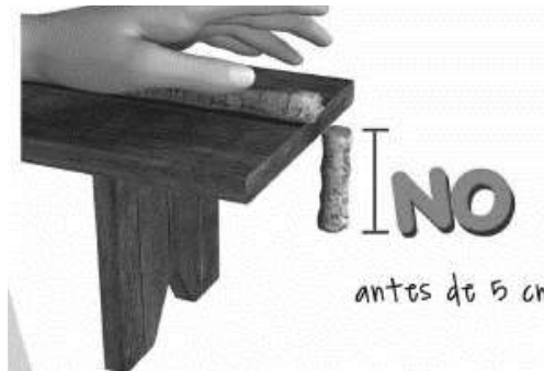
Ilustración 88. No posee suficiente barro
