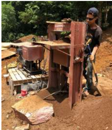
Ilustración 112. Elaboración de adobe estabilizado
