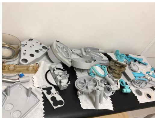
Ilustración 14 Desarmado y desinfección de módulo de ventilación en máquina de anestesia
