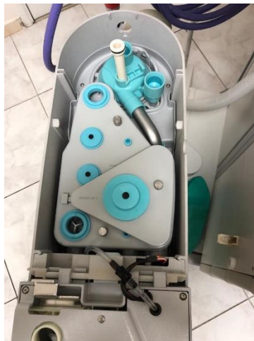
Ilustración 16 Armado de módulo de ventilación de máquina de anestesia
