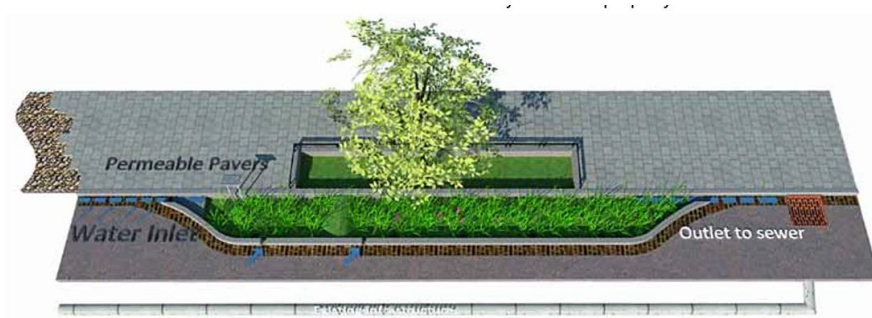
Ilustración 8 Corte transversal de un resalte de bordillo con adoquines permeables en la acera. Fuente: (Neosho, 2013)
