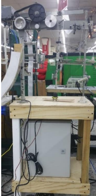
Ilustración 23. Ubicación de panel de control en estructura
