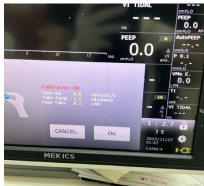
Ilustración 50: Ejemplo de calibración de circuito de paciente sin fugas de un VM
