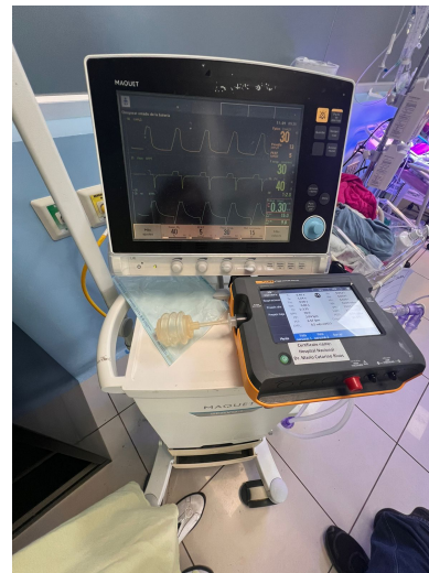
Ilustración 52: Calibración de VM Maquet Servo-i
