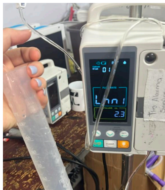
Ilustración 70: Pruebas de funcionamiento a Bombas de Infusión
