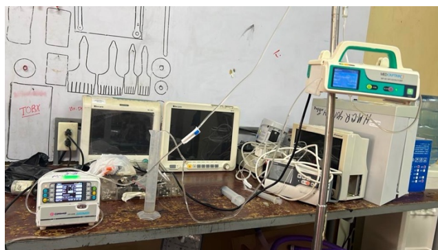
Ilustración 35: Calibración de Bombas de Infusión
