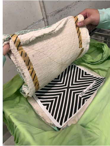
Ilustración 62: Prueba de Bowie Dick en Autoclave Steris
