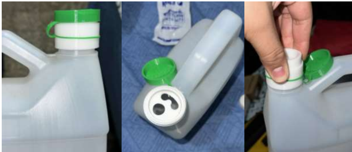
Ilustración 15 - Prototipo finalizado impreso en 3D.
