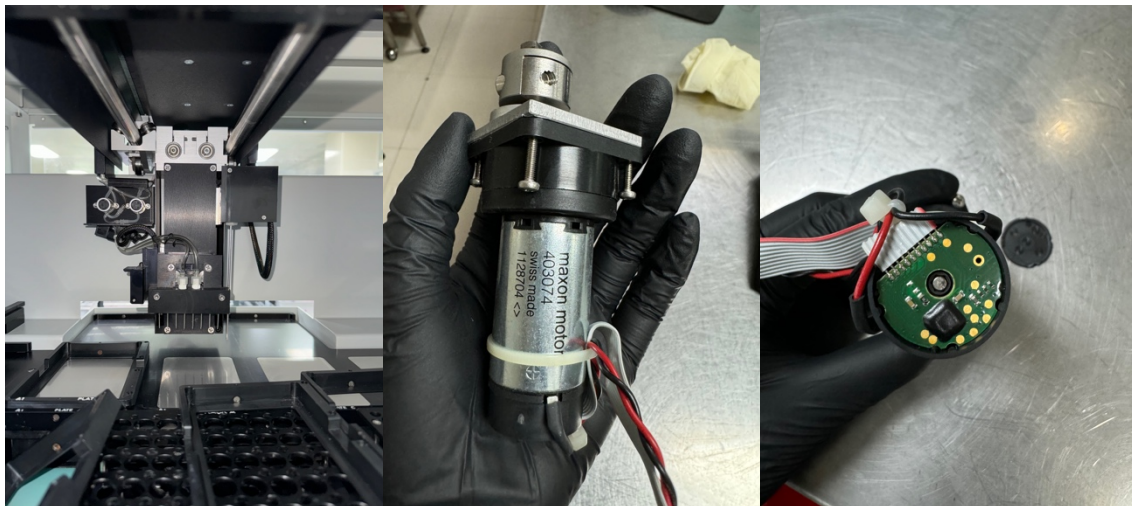
Ilustración 32. Mantenimiento Correctivo Analizador ELISA - S6
