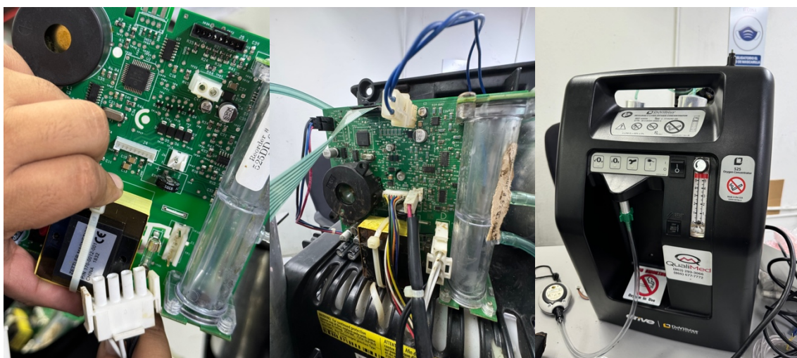
Ilustración 33. Mantenimiento Correctivo - Cambio de PCB Concentrador de O2
