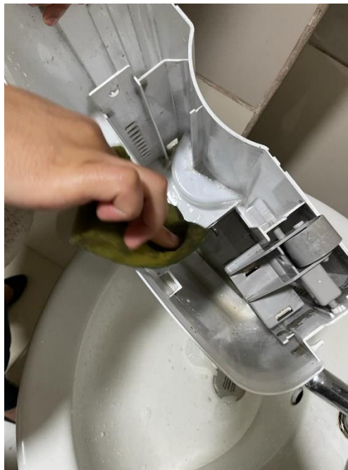
Anexo 17. Lavado de deshumidificador
