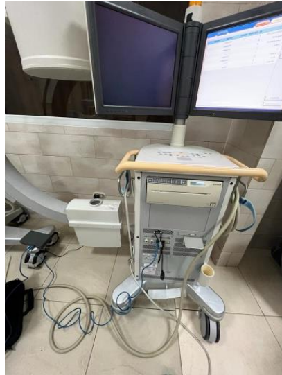
Ilustración 31. Brazo en C Philips Pulsera en proceso de conexión con plataforma BVscope.
