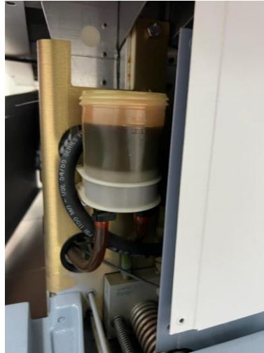
Ilustración 28. Tanque de aceite hidráulico de mesa de RM GE Signa HDxt 1.5T.
