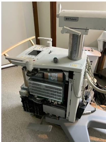
Ilustración 18. Brazo en C Philips Pulsara durante mantenimiento preventivo.
