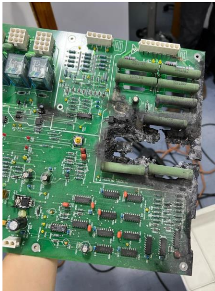
Ilustración 20. Tarjeta madre averiada de PDU de tomógrafo Lightspeed VCT.
