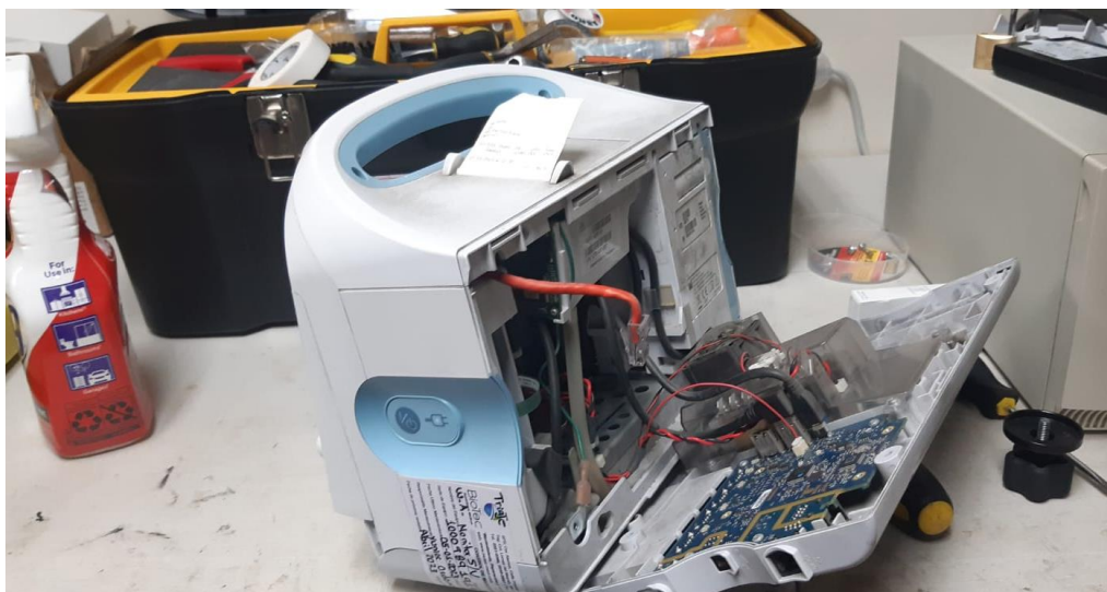
Ilustración 56: Revisión y limpieza interna de monitor Welch Allyn
