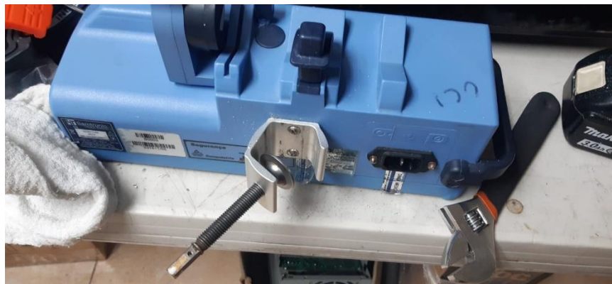
Ilustración 52: Pieza con tornillo barrido de la empuja jeringa
