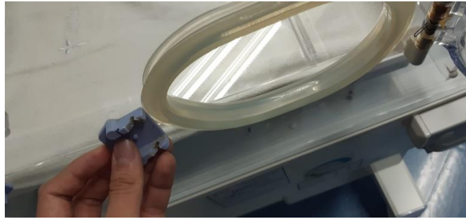
Ilustración 41: Incubadora cerrada con compuerta dañada
