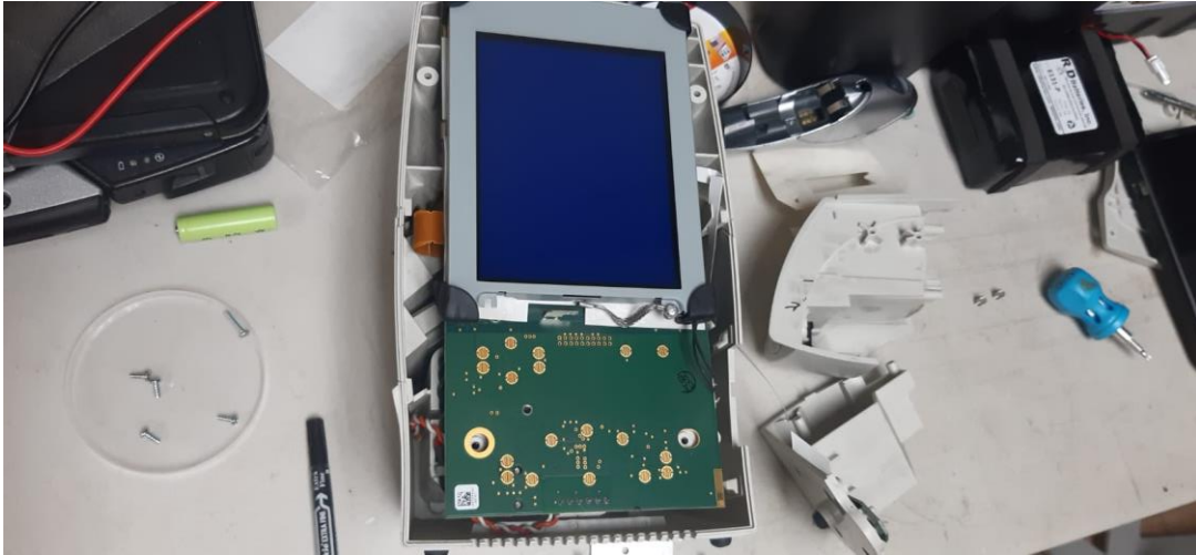
Ilustración 38: Revisión interna y MC a Monitor SV Welch Allyn LXi
