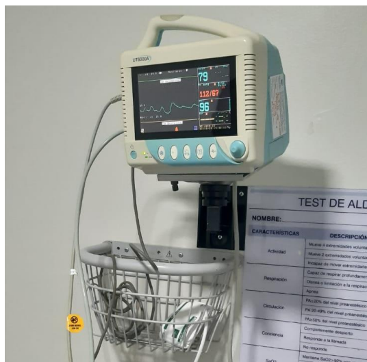
Ilustración 5: Monitor con módulos de PNI y oximetría en mal estado
