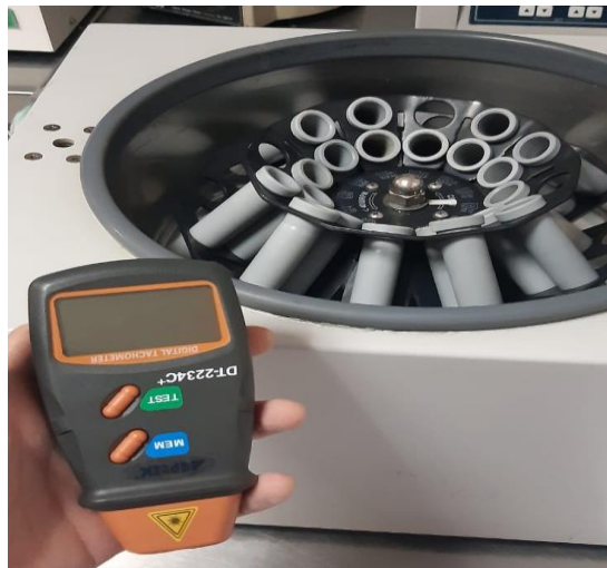
Ilustración 20: Tacómetro marca AGPTEK para la medición del rpm
