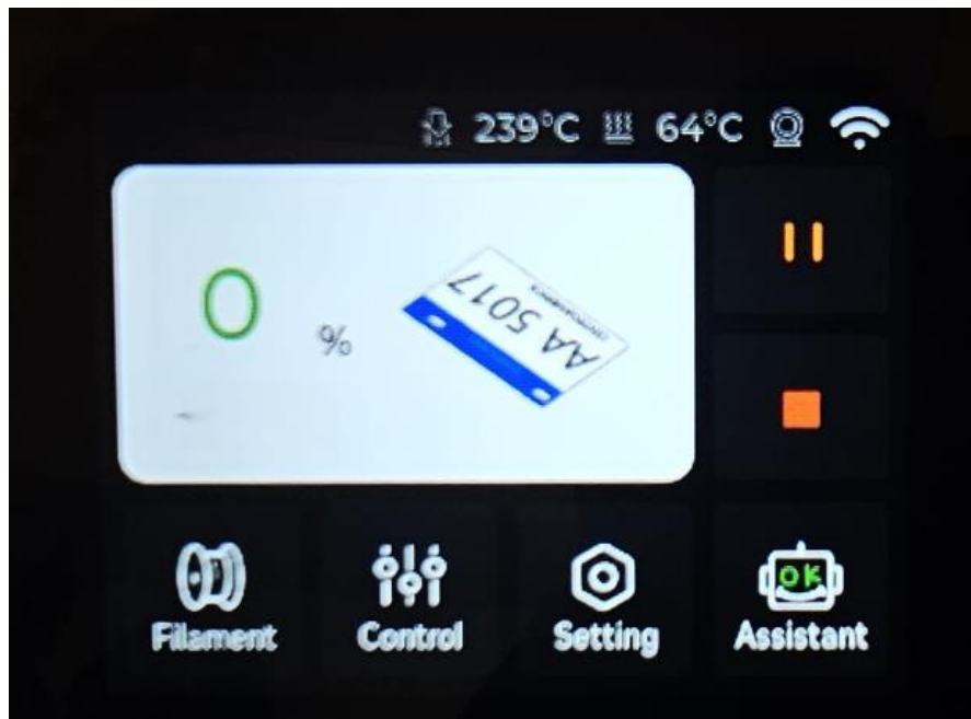
Ilustración 6 Pantalla de Bambu Lab A1 con especificaciones térmicas
