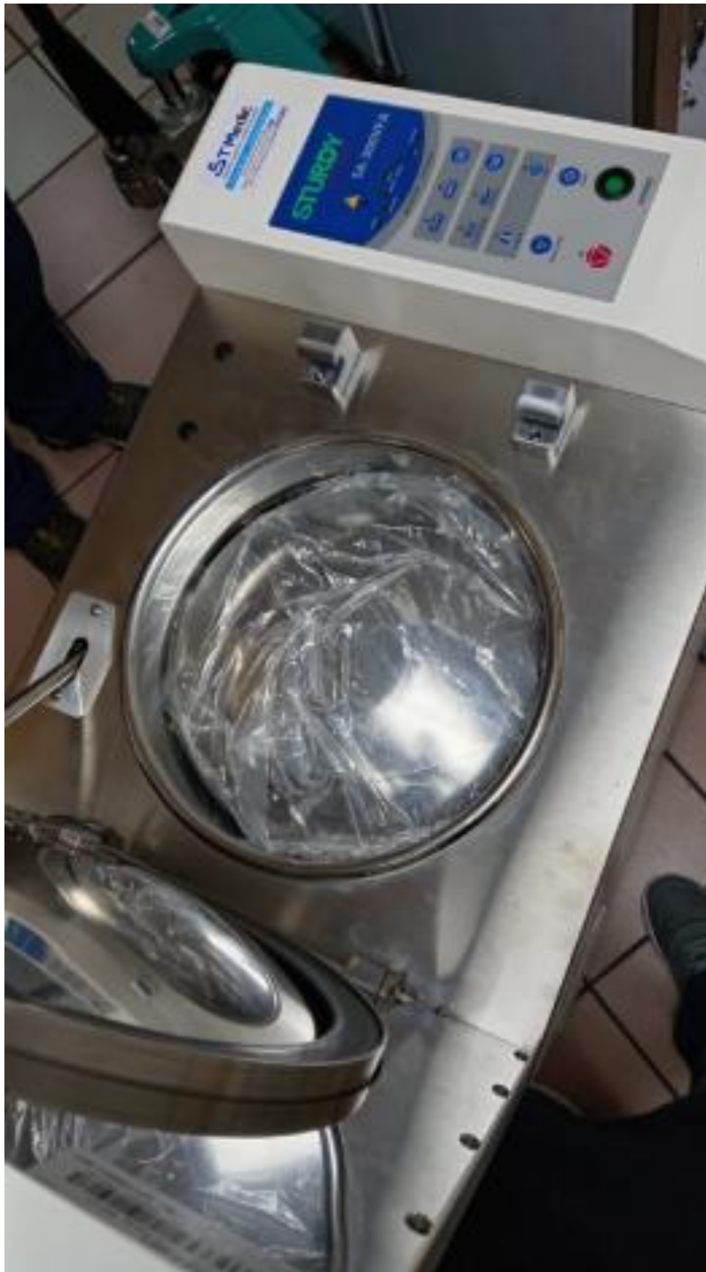
Ilustración 13. Recepción y prueba de funcionamiento de autoclave
