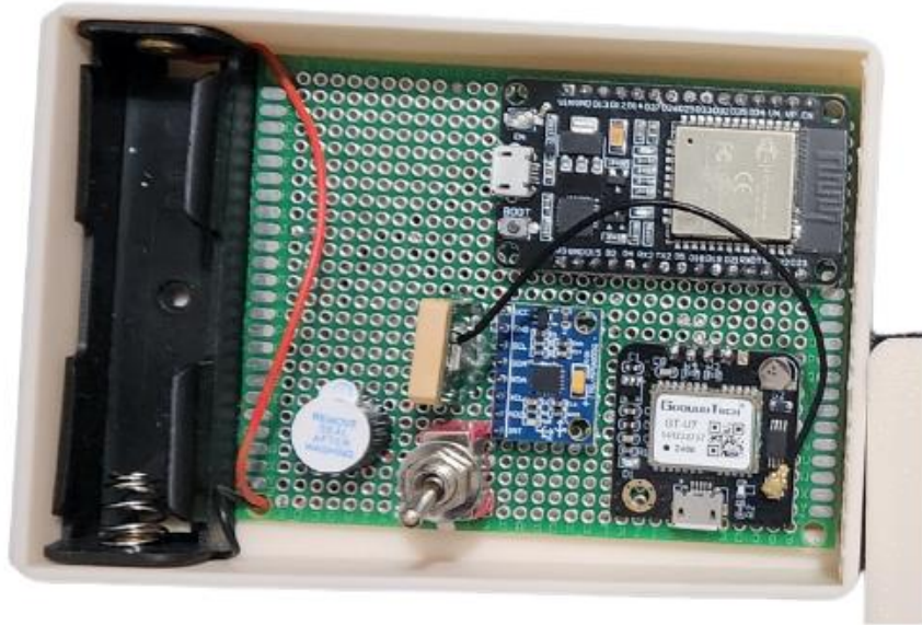
Ilustración 14: Soldadura de componentes.
