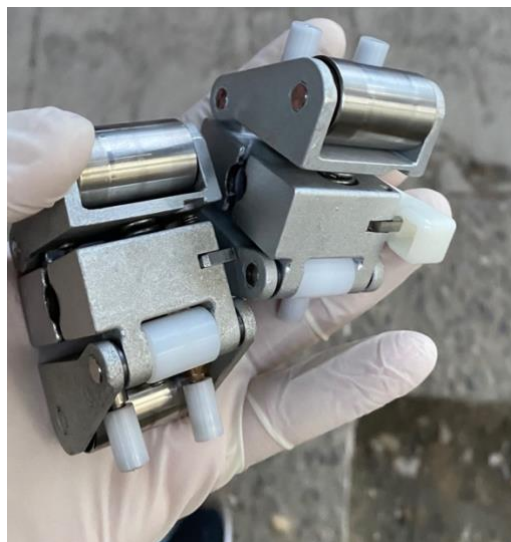
Ilustración 35. Bombas peristálticas para reemplazar.
