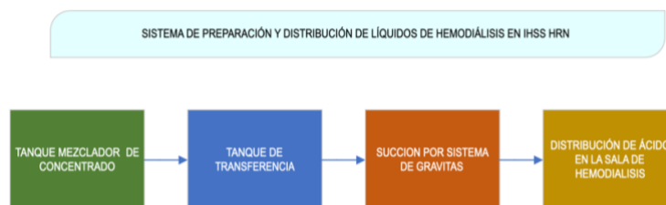
Ilustración 5. Diagrama de funcionamiento de sistema de preparación y distribución de líquidos de hemodiálisis.
