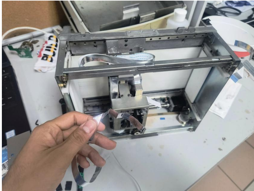
Ilustración 34: Cable flat retirado de la trazadora.
