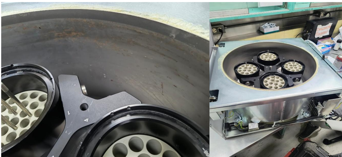
Ilustración 60: A. Rotor con sangre seca. B. Centrifuga destapada.
