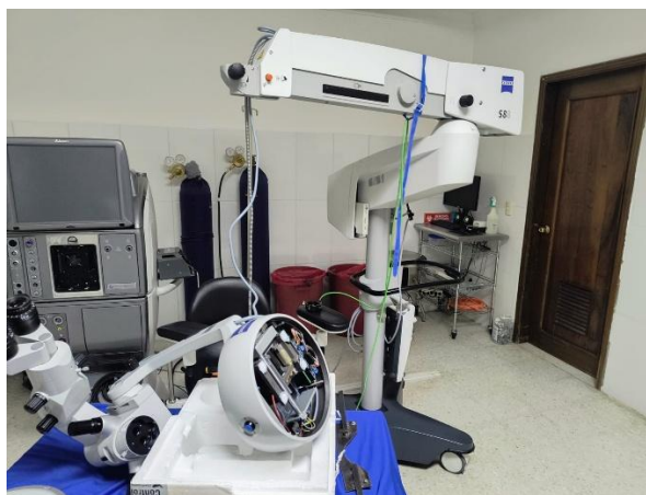
Ilustración 22: Desmontaje de la pieza XY del microscopio quirúrgico.
