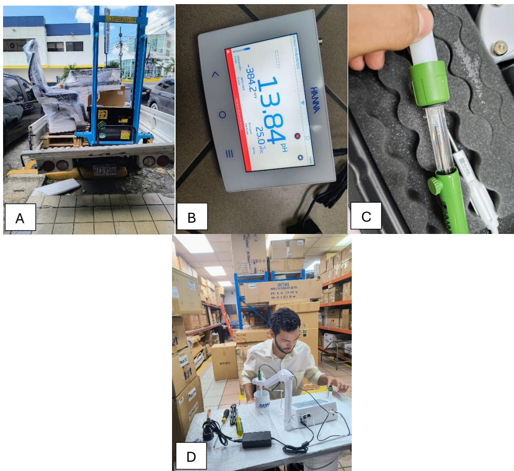
Ilustración 33: A. Silla oftalmológica. B. Medidor de pH sin su electrodo conectado. C. Electrodo de pH con mineralización presente. D. Ejecución de pruebas de medición de pH y de temperatura.
