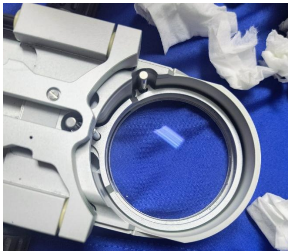
Ilustración 23: Limpieza de ópticas del microscopio quirúrgico.
