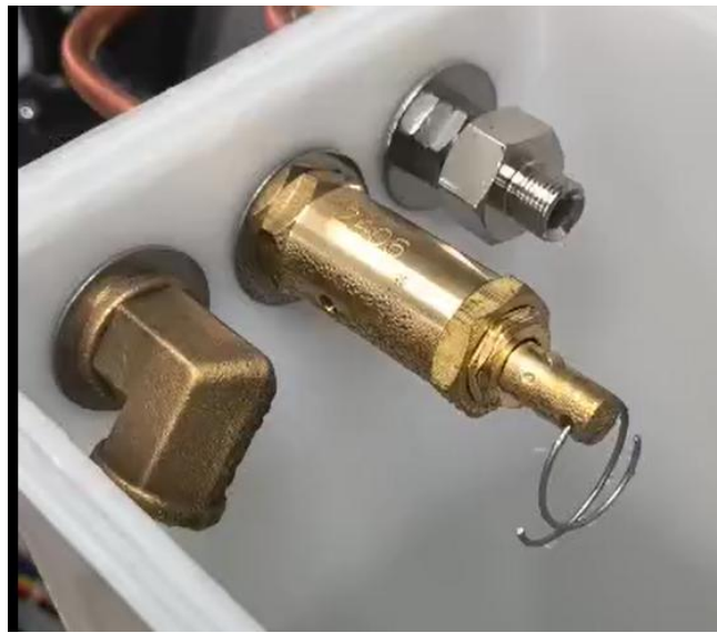
Anexo 13: Válvulas de alivio y emergencia de esterilizador.
