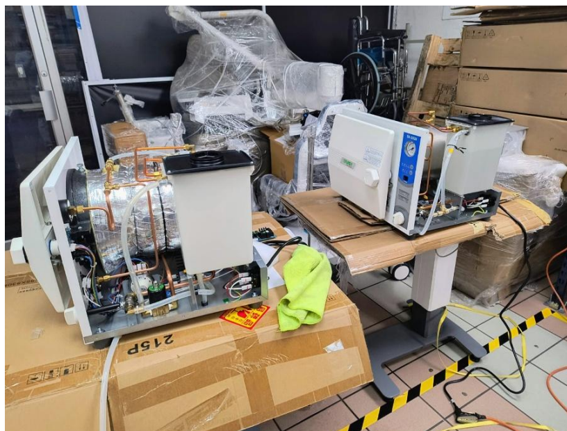
Ilustración 25: Cambio de tarjeta principal entre los esterilizadores.
