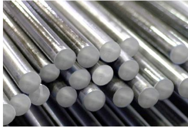
Figura 76 Acero SAE 1045 barra para maquinado
