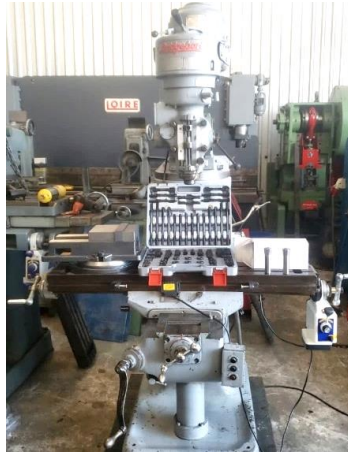
Figura 68 Fresadora universal Bridgeport con cabezal divisor
