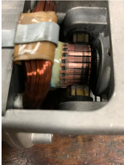
Ilustración 25 Conexión de escobillas con rotor
