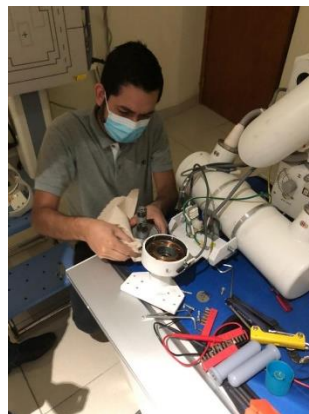
Ilustración 30 Realizando mantenimiento a magneto de tubo de rayos X
