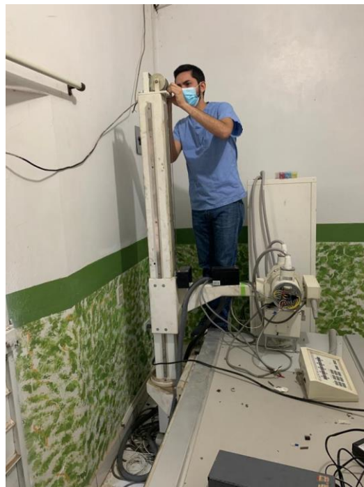
Ilustración 32 Reemplazando magneto de movimiento en Y
