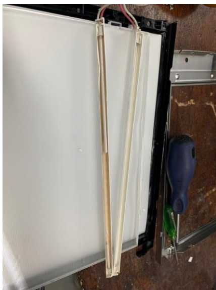
Ilustración 21 Problema encontrado en iluminación de la pantalla
