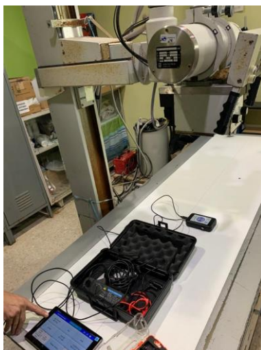
Ilustración 46 Prueba de Kvp a máquina de rayos X
