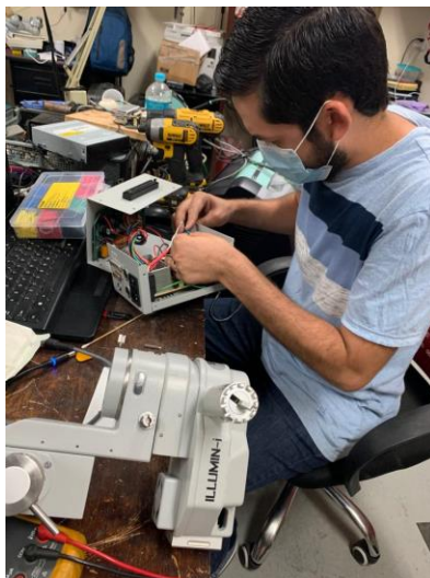
Ilustración 41 Reemplazo de placa generadora de voltaje
