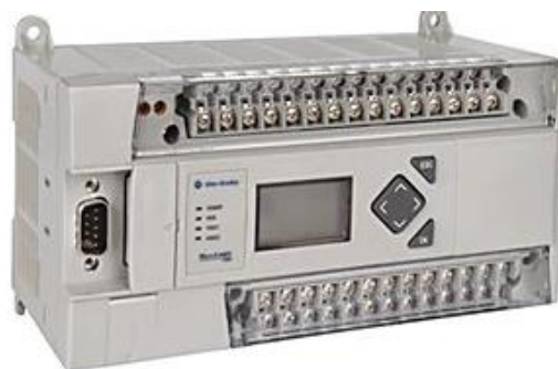
Ilustración 21. PLC Allen Bradley
