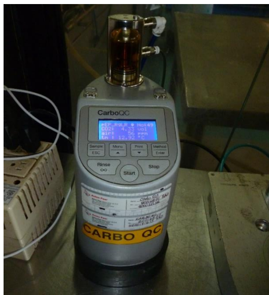
Ilustración 30. Dispositivo para medir el \text{CO}_2 en las bebidas carbonatadas
