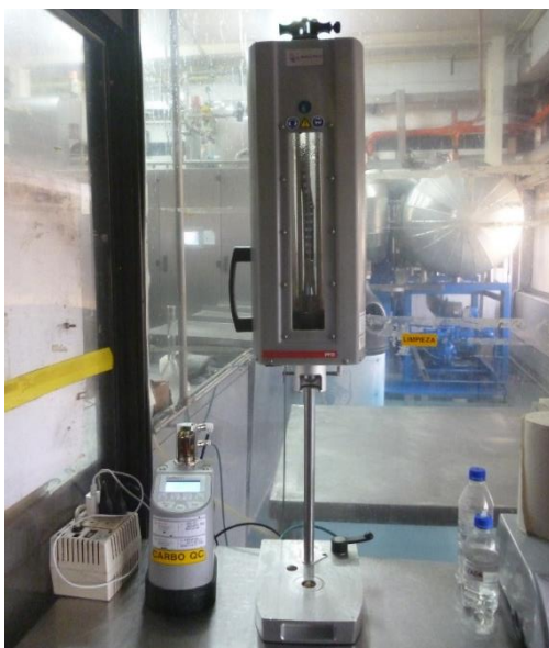
Ilustración 30. Dispositivo para medir el \text{CO}_2 en las bebidas carbonatadas
