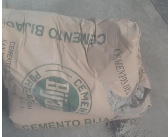
Ilustración 38. Rotura en bolsa de cemento bijao.
