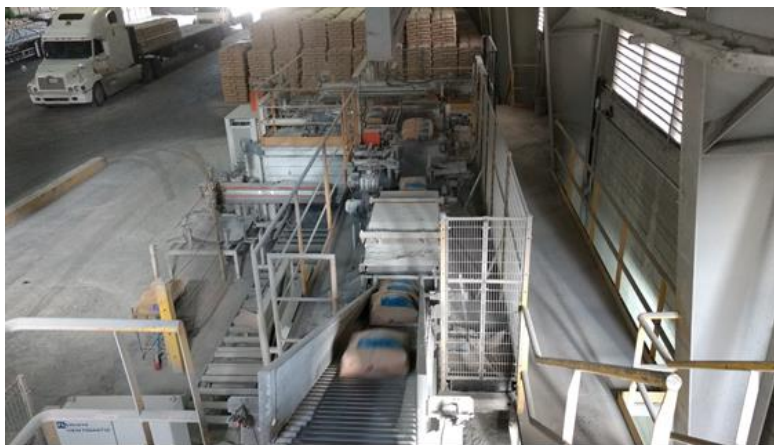
Ilustración 21. Banda prensadora de sacos POLIMAT C40 de envasadora 3.
