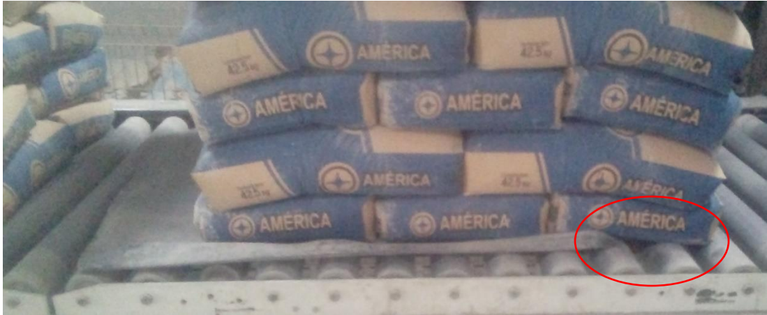
Ilustración 25. Carpeta plástica mal posicionada o pasada.
