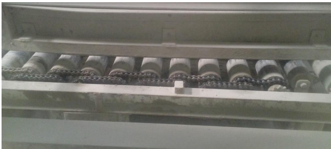
Ilustración 29. Cadena de vía de rodillos paletizadora POLIMAT C40.
