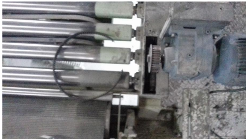
Ilustración 19. Banda motriz vía de rodillos POLIMAT C40.
