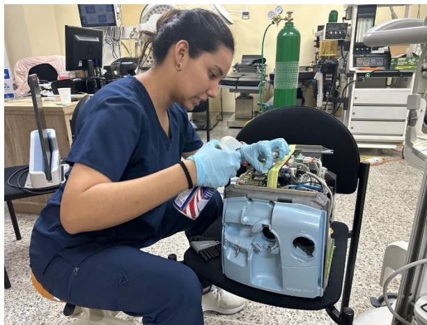
Ilustración 38: revisión de Ventilador
