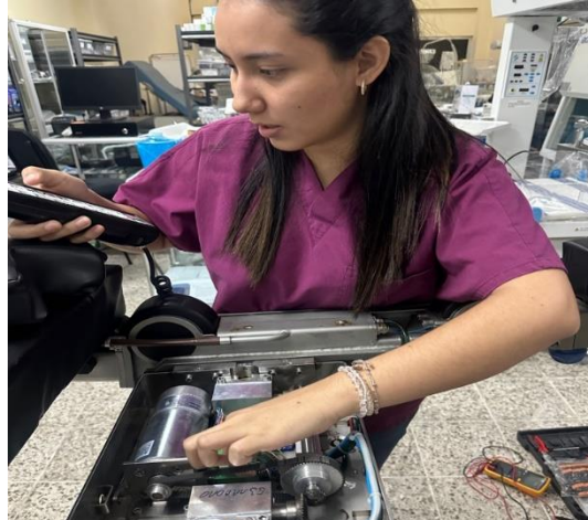
Ilustración 19: Mantenimiento mesa quirúrgica TITAN
