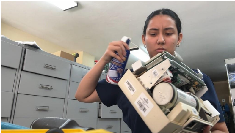
Ilustración 37: Arreglo de desfibrilador
