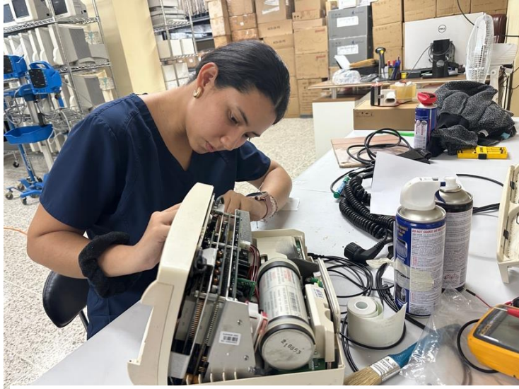
Ilustración 20: Verificando batería BIOS
