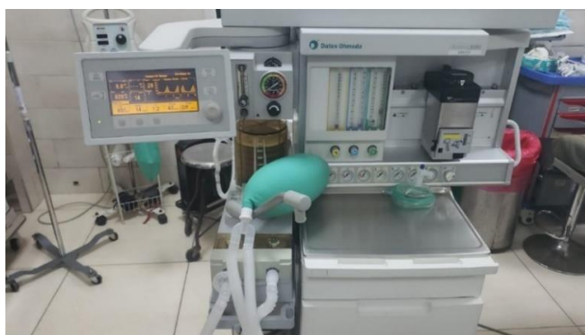
Ilustración 24. Error de Vt compensation off en máquina de anestesia Datex-Ohmeda en Clínica Murillo.
