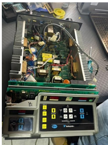
Ilustración 32. Reparación de una unidad de electrocirugía Force 2.
