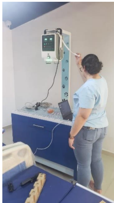
Ilustración 21. Pruebas de funcionamiento de la estación de rayos X veterinario.
