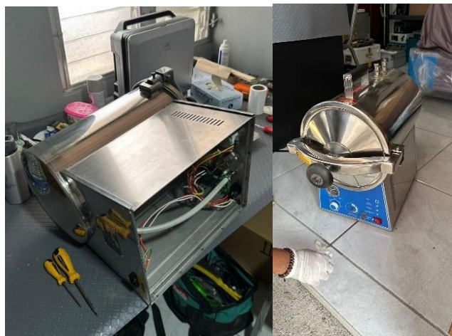
Ilustración 30. Revisión de autoclave.
