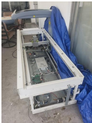
Ilustración 39. Revisión de densitómetro con falla grave.
