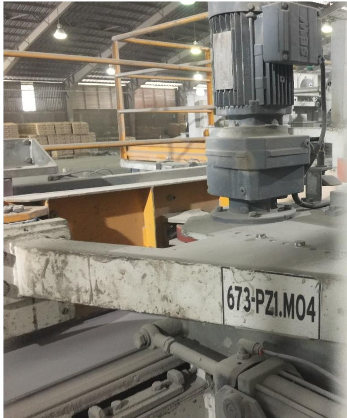
Ilustración 22. Paleta gira sacos en Paletizadora POLIMAT C40.
