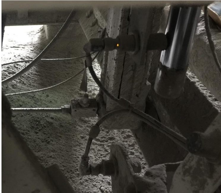
Ilustración 19. Rose de Interruptor de proximidad en barra de nivel en Aplicador de Sacos INFILTO Z40.
