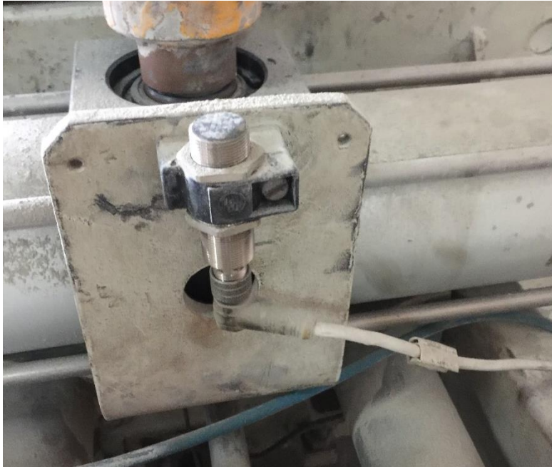
Ilustración 20. Suciedad en Interruptor de Proximidad que detecta el rastrillo del Aplicador de Sacos INFILTRO Z40.
