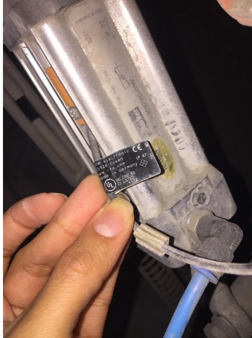
Ilustración 17. Sensor Incrustado en pistón de soporte en NORIAMAT.
