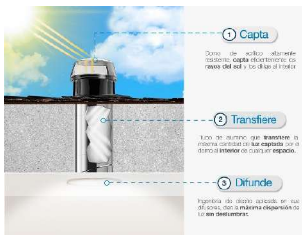
Figura 35 Domo solar "Solatube"
