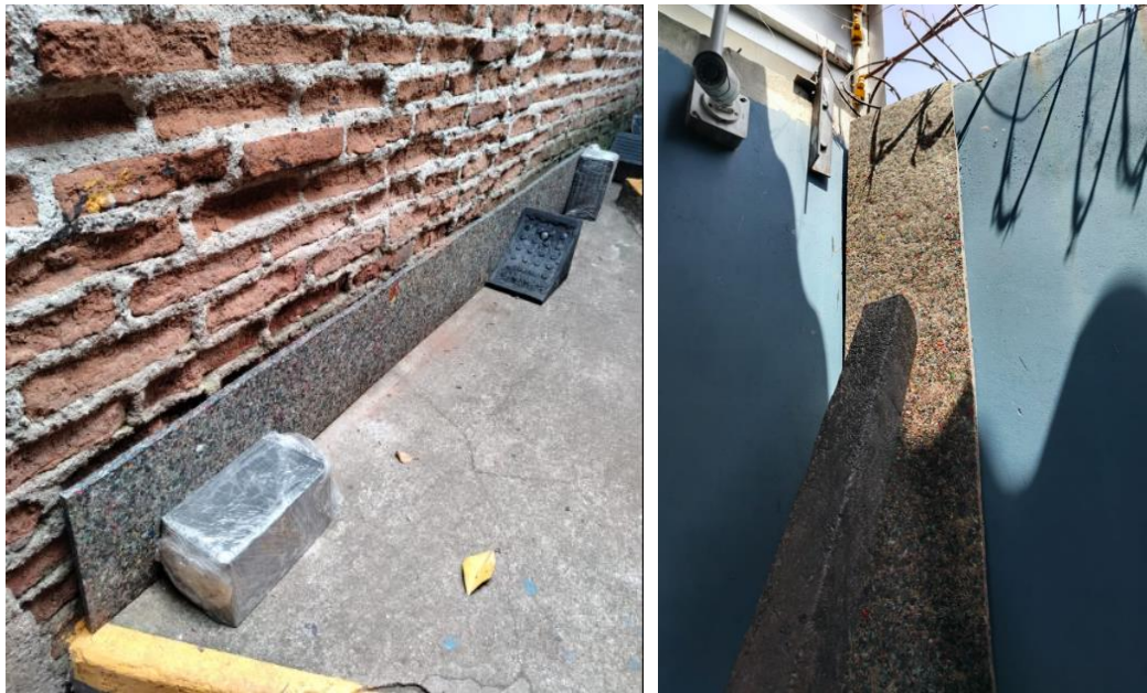
ANEXO 6 -PRUEBA DE EXPOSICIÓN A LA INTEMPERIE DE TABLAS EN POSICIÓN HORIZONTAL Y VERTICAL
