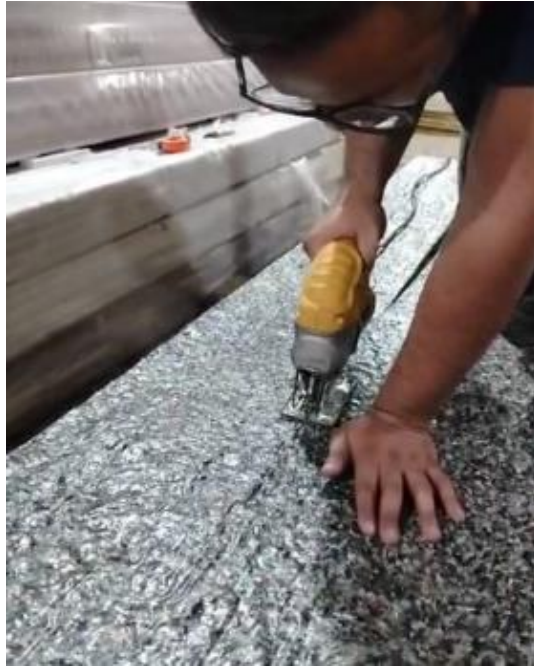
ANEXO 1 -PRUEBA DE CORTE CON CALADORA
