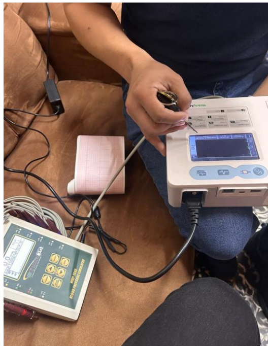
Anexo 20. Pruebas con simulador de frecuencia cardíaca en ECG
